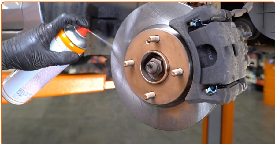
Die Bremsscheibenoberfläche reinigen. Benutzen Sie einen Bremsenreiniger.
