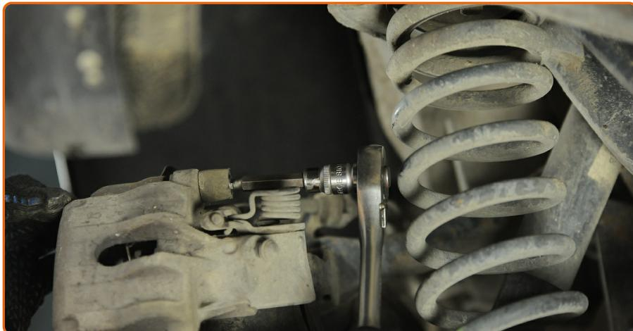
Schrauben Sie die Befestigung des Bremssattels ab. Verwenden Sie Inbusschlüssel Nr. H7.
