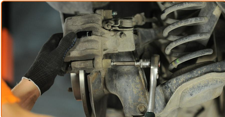
Ziehen Sie die Bremssattelbefestigungen fest. Verwenden Sie Inbusschlüssel Nr. H7.
