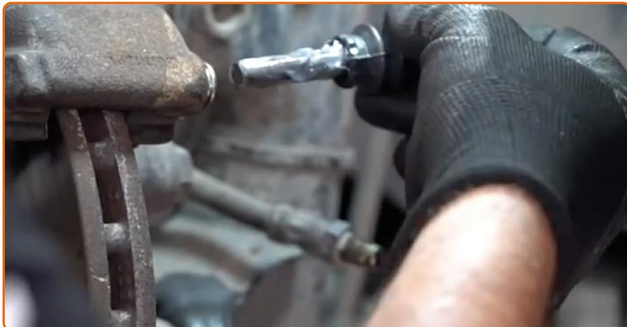
Schrauben Sie die Führungsbolzen hinein.
