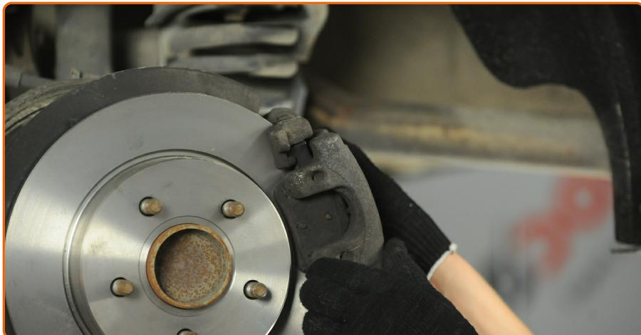
Entfernen Sie den Bremssattel.
