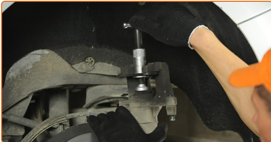
Drücken Sie den Bremssattelkolben rein. Verwenden Sie den Bremskolbenrücksteller.
