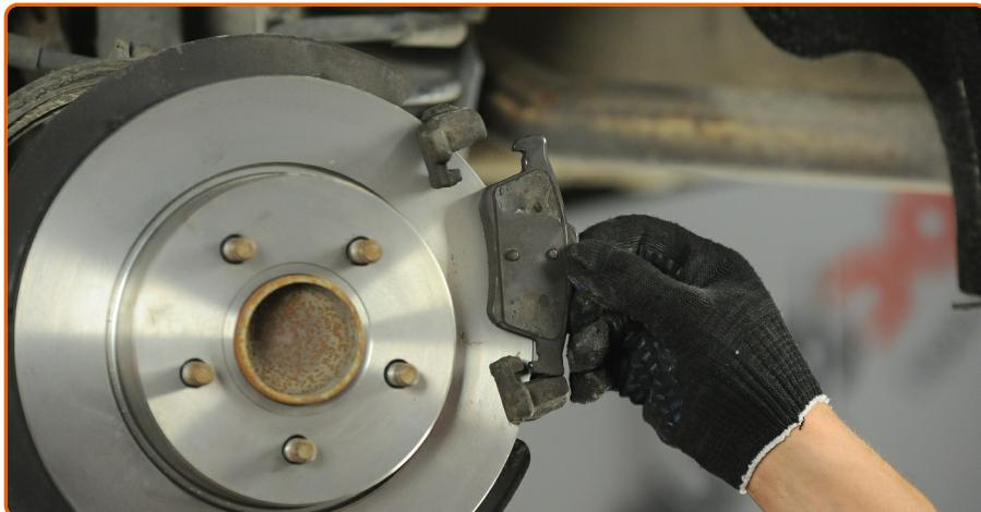
Entfernen Sie die Bremsbeläge.
