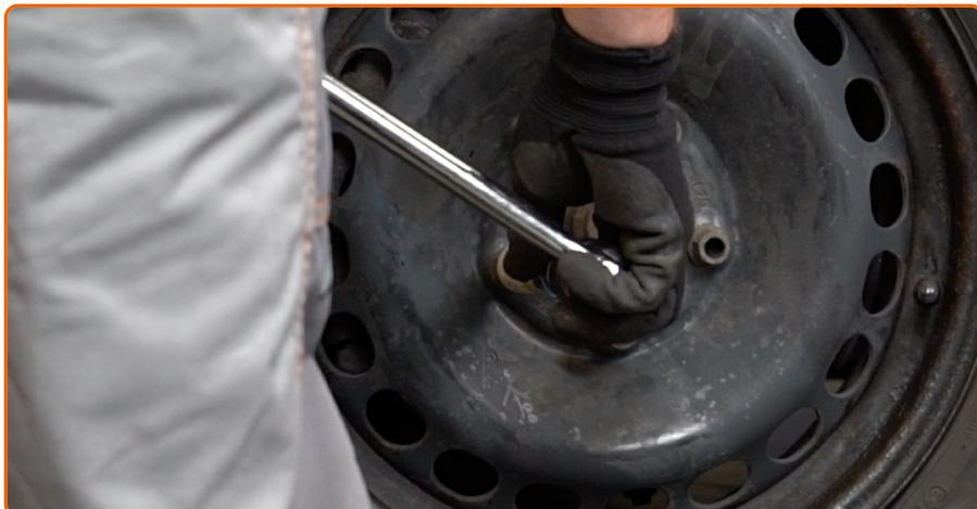
Lösen Sie die Radhalterungsschrauben. Verwenden Sie eine Schlagnuss für Felgen # 19.
