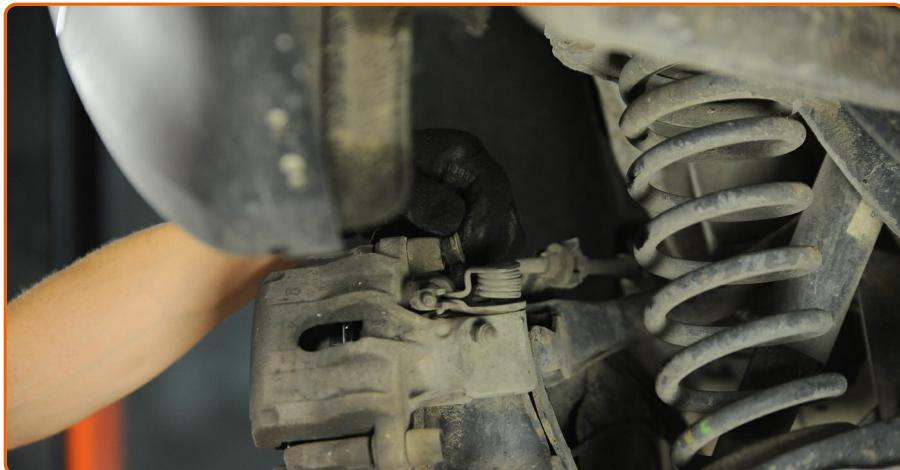
Installieren Sie die Staubschutzkappen der Bremssattel-Führungsstifte.
