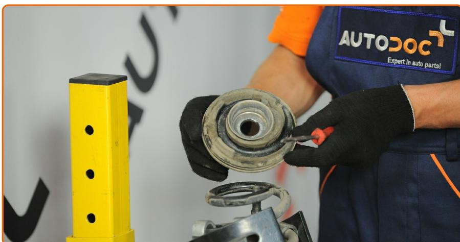
Entfernen Sie das obere Domlager. Verwenden Sie einen flachen Schraubendreher.
