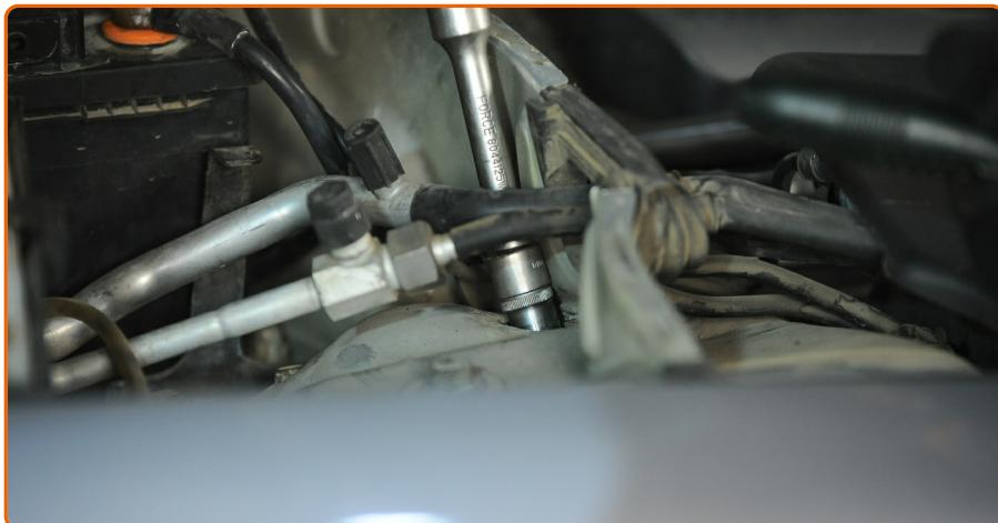
Ziehen Sie die obere Befestigung des Domlagers fest. Verwenden Sie Stecknuss Nr. 13. Verwenden Sie einen Drehmomentschlüssel. Ziehen Sie ihn mit 65 Nm Drehmoment fest. Bringen Sie die Kappe des Federbeinstützlagers an. Verwenden Sie einen flachen Schraubendreher.
