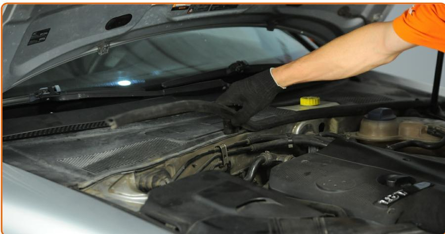
Entfernen Sie die Dichtung der Windabweiserabdeckung.
