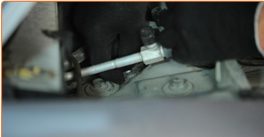
Entfernen Sie die Kappe des Federbeinstützlagers. Verwenden Sie einen flachen Schraubendreher.
