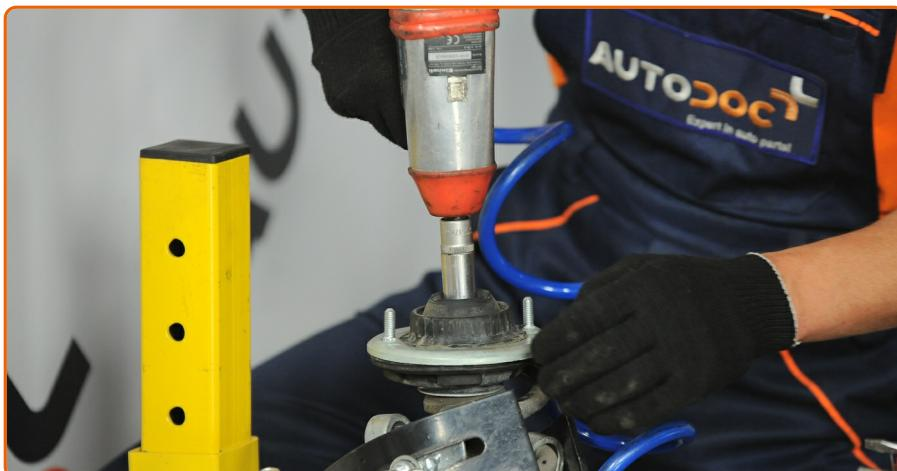
Ziehen Sie die Federbeinkolbenstangenmutter an. Verwenden Sie Inbusschlüssel Nr. H5. Verwenden Sie Stecknuss Nr. 19. Verwenden Sie einen Drehmomentschlüssel. Ziehen Sie ihn mit 60 Nm Drehmoment fest.
