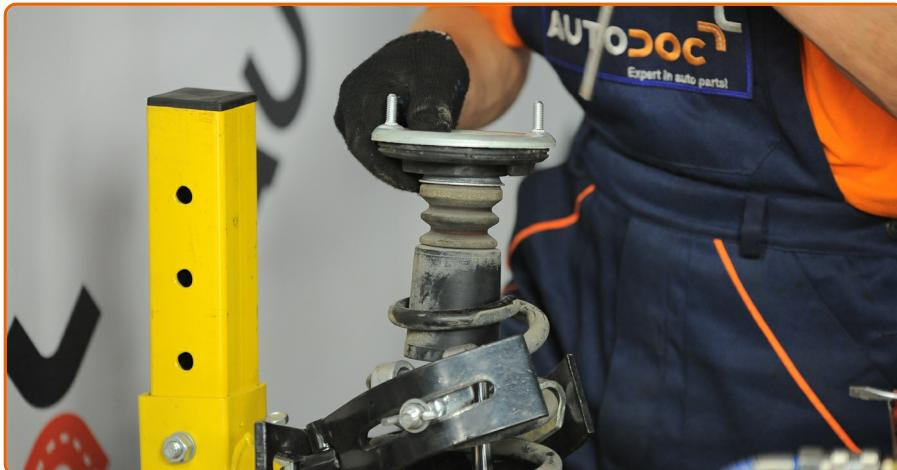
Installieren Sie eine neue Federbeinlager.
