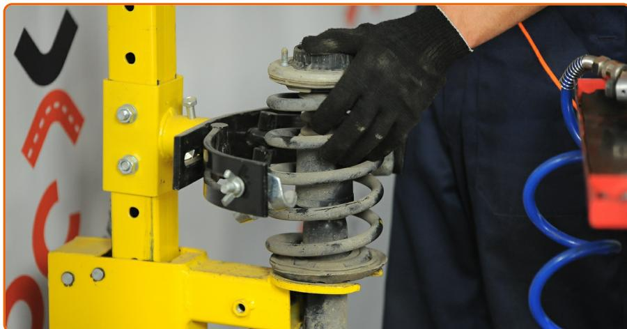
Stellen Sie das Dämpferbein auf das Federspannwerkzeug.
