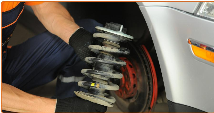
Entfernen Sie das zusammengebaute Federbein.
