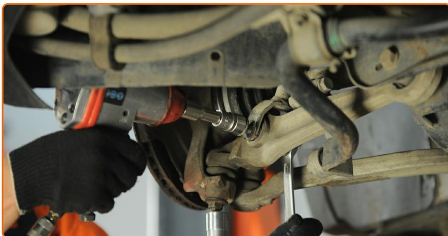
Ziehen Sie die Befestigungsschraube an, die die Stoßdämpfergabel mit dem unteren Querlenker verbindet. Verwenden Sie Ring-Gabelschlüssel Nr. 18. Verwenden Sie Stecknuss Nr. 18. Verwenden Sie einen Drehmomentschlüssel. Ziehen Sie ihn mit 95 Nm Drehmoment fest.
