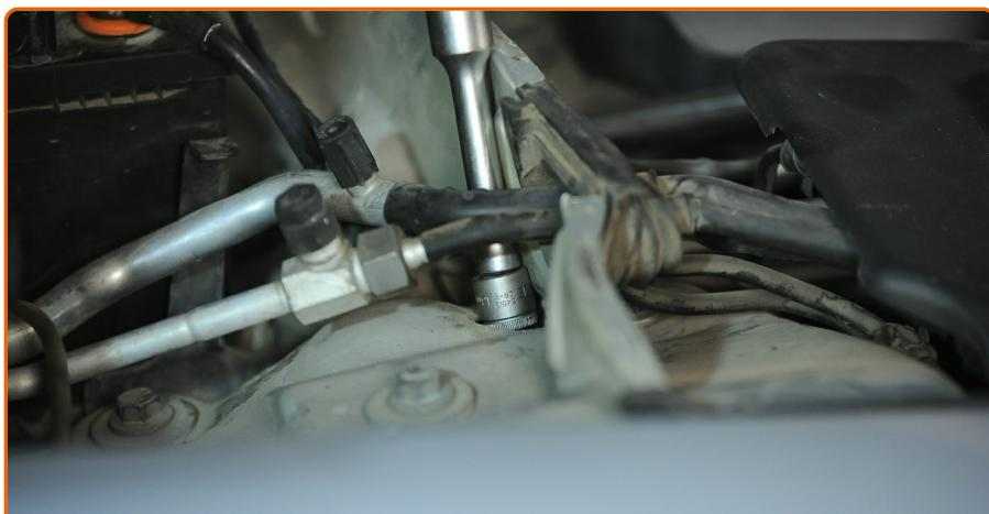
Lösen Sie die obere Befestigung des Federbeins. Verwenden Sie Stecknuss Nr. 13. Verwenden Sie einen Ratschenschlüssel.
