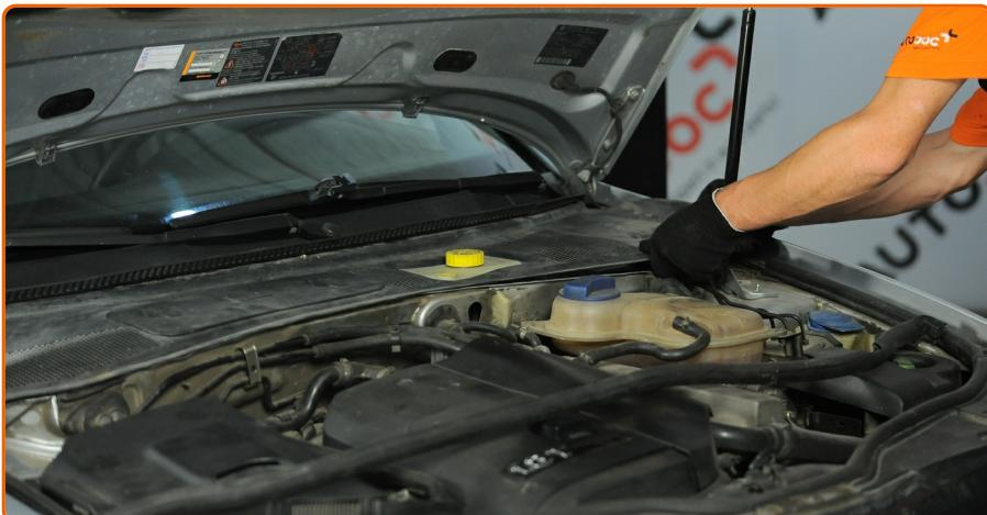
Bauen Sie die Dichtung der Windabweiserabdeckung ein.
