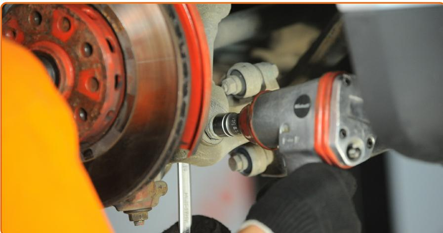
Schrauben Sie die Befestigungsschraube heraus, die die Stoßdämpfergabel mit dem unteren Querlenker verbindet. Verwenden Sie Ring-Gabelschlüssel Nr. 18. Verwenden Sie Stecknuss Nr. 18. Verwenden Sie einen Ratschenschlüssel.
