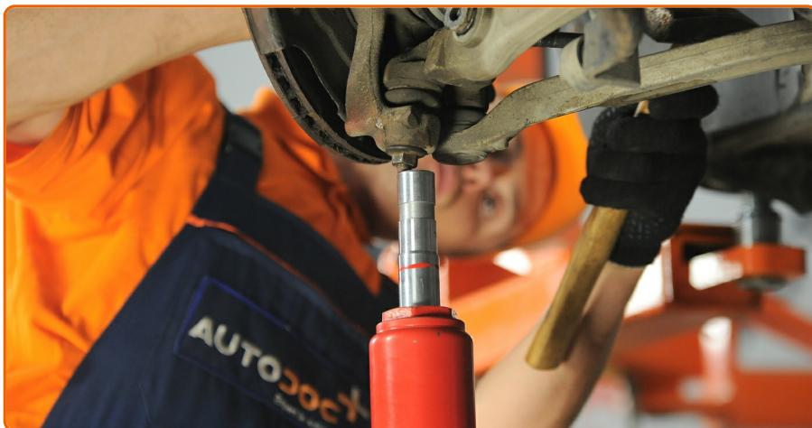
Heben Sie den hydraulischen Getriebeheber um 10–15 cm an.
