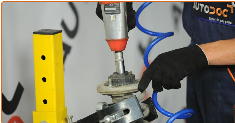
Entfernen Sie die Stangenmutter des Federkolben. Verwenden Sie Stecknuss Nr. 19.
