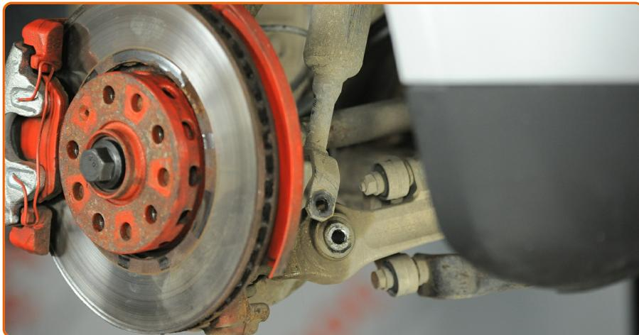
Entfernen Sie die Befestigungsschraube. Verwenden Sie einen Splintentreiber. Benutzen Sie einen Hammer.
