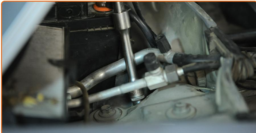
Schrauben Sie die obere Befestigung des Domlagers an.
