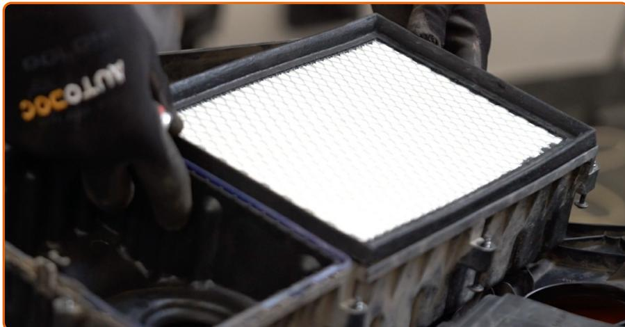
Setzen Sie ein neues Filterelement in das Filtergehäuse. Stellen Sie sicher, dass die Filterkante dicht am Gehäuse ansitzt.
