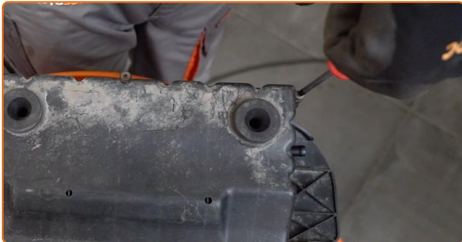
Drehen Sie die Befestigungsschrauben der Luftfilter-Abdeckung ein. Verwenden Sie einen Kreuzschlitzschraubendreher.
