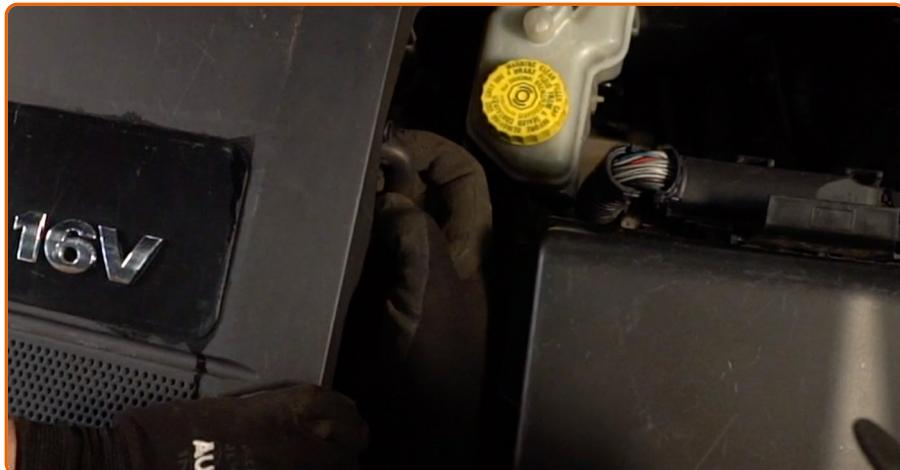
Verbinden Sie den Kurbelgehäuse-Entlüftungsschlauch mit der Motorhaube zur Linken.
