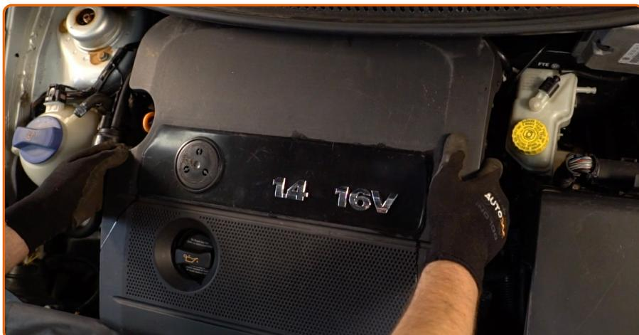
Installieren Sie die Motorabdeckung und sichern Sie diese. Stellen Sie sicher, dass Sie dabei das Klicken hören, welches entsteht, wenn sich diese in der korrekten Position befindet.
