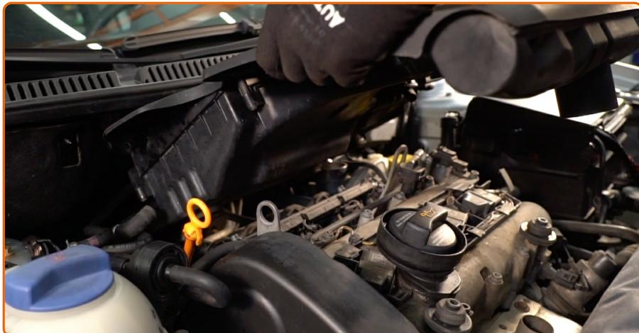
Entfernen Sie die Motorabdeckung. Das Luftfiltergehäuse ist in der Motorhaube integriert.
