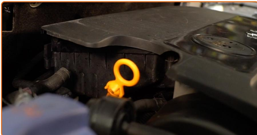
Trennen Sie den Kurbelgehäuse-Entlüftungsschlauch von der Motorhaube zur Linken.
