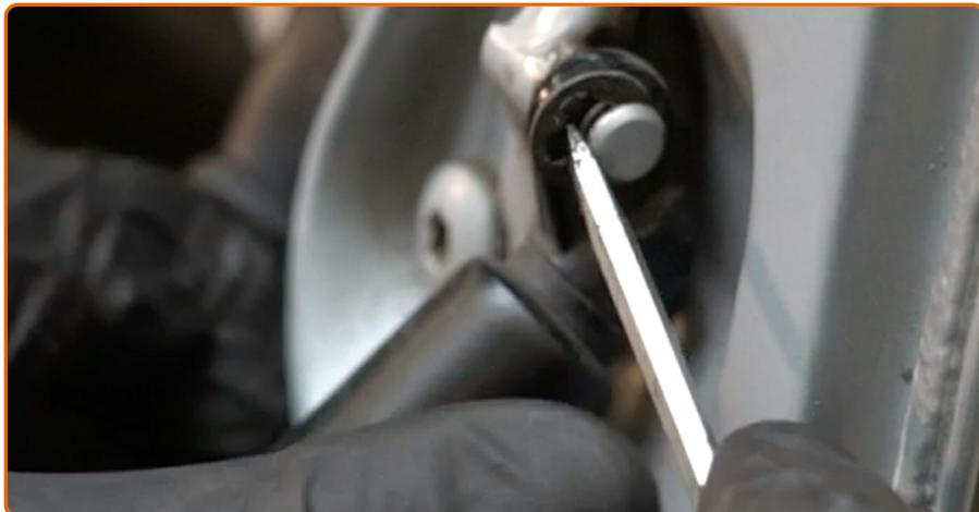
Lösen Sie den Sicherungsring, der die Gasfeder mit dem Kofferraumdeckel verbindet.
