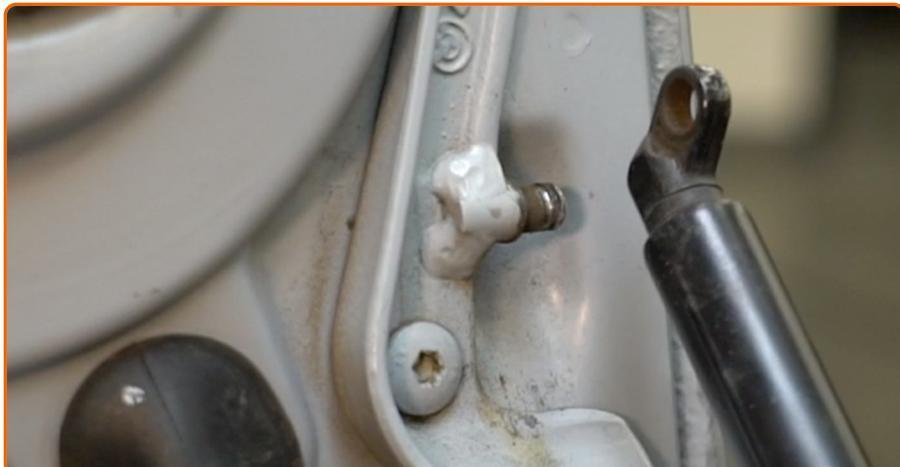
Entfernen Sie die Gasfeder des Kofferraumdeckels.
