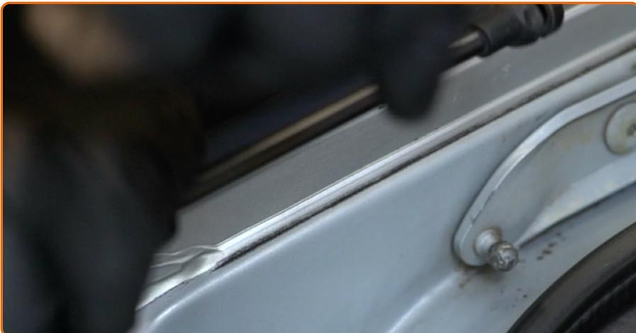
Entfernen Sie die Gasfeder des Kofferraumdeckels.
