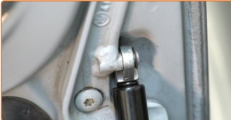
Lassen Sie den Sprengring, der die Gasfeder mit dem Kofferraumdeckel verbindet, einrasten.
