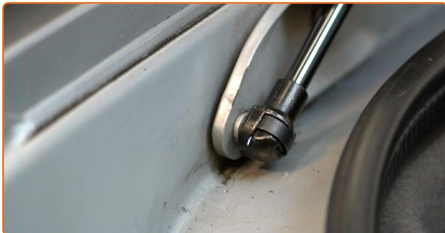
Lassen Sie den Sprengring, der die Gasfeder mit der Karosserie verbindet, einrasten.
