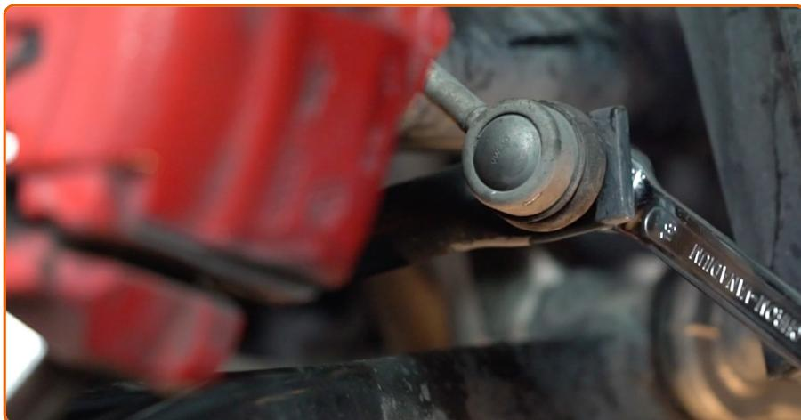
Schrauben Sie das Befestigungselement heraus, das die Druckstange mit dem Stabilisator verbindet. Verwenden Sie Ring-Gabelschlüssel Nr. 18. Benutzen Sie den XZN #6. Verwenden Sie einen Ratschenschlüssel.
