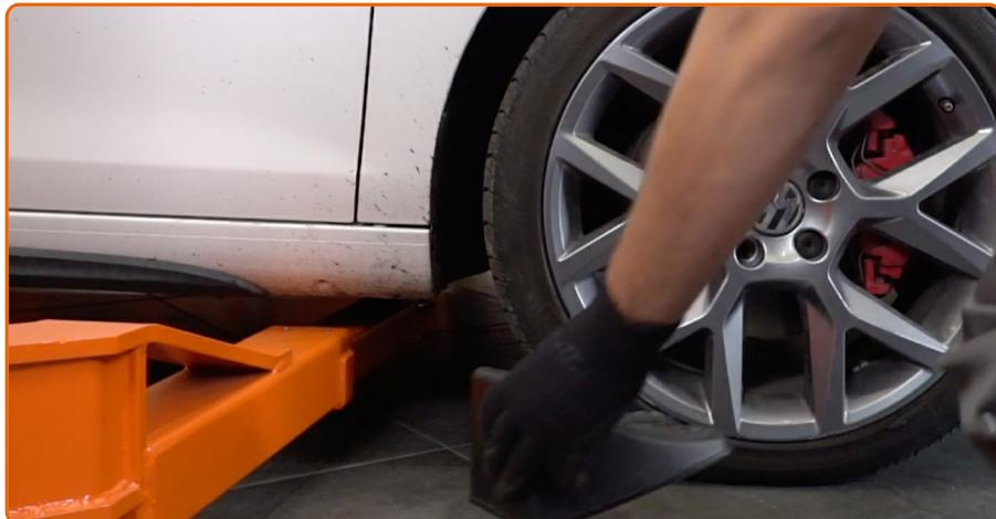
Entfernen Sie den Wagenheber sowie die Unterlegkeile.
