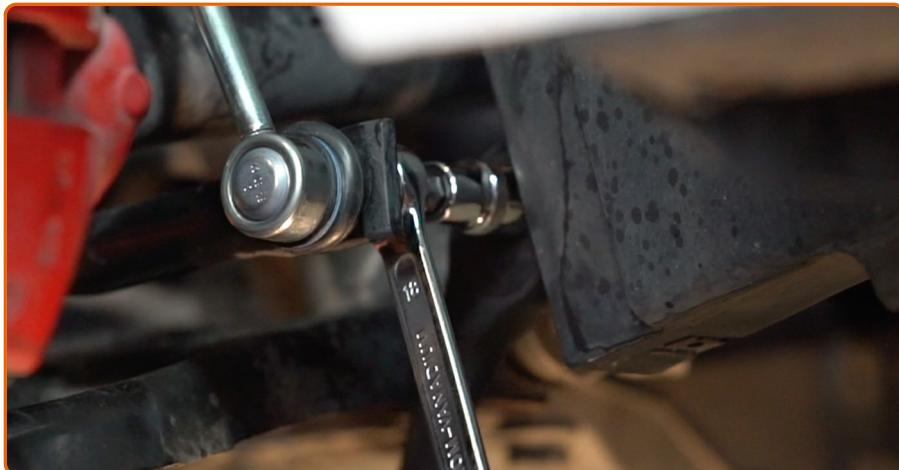
Ziehen Sie das Befestigungselement an, das die Druckstange mit dem Stabilisator verbindet. Verwenden Sie Ring-Gabelschlüssel Nr. 18. Benutzen Sie den XZN #6. Verwenden Sie einen Drehmomentschlüssel. Ziehen Sie ihn mit 55 Nm Drehmoment fest.
