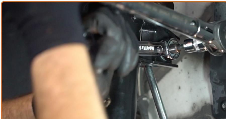
Ziehen Sie das Befestigungselement an, das die Druckstange mit dem Federbein verbindet. Verwenden Sie Ring-Gabelschlüssel Nr. 18. Benutzen Sie den XZN #6. Verwenden Sie einen Drehmomentschlüssel. Ziehen Sie ihn mit 55 Nm Drehmoment fest.
