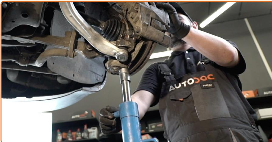
Entfernen Sie den Träger unter dem Arm.
