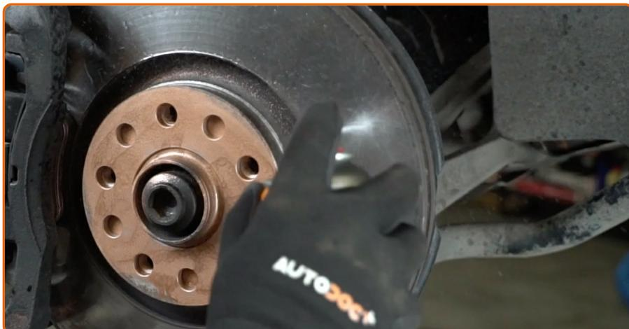
Die Bremsscheibenoberfläche reinigen. Benutzen Sie einen Bremsenreiniger.
