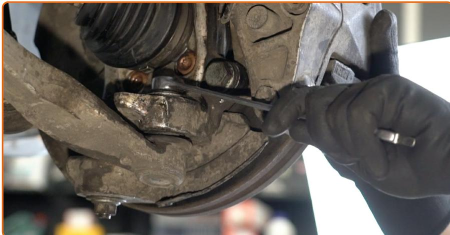
Schrauben Sie die Kugelgelenkbefestigung vom Achsschenkel ab. Verwenden Sie Ring-Gabelschlüssel Nr. 18.
