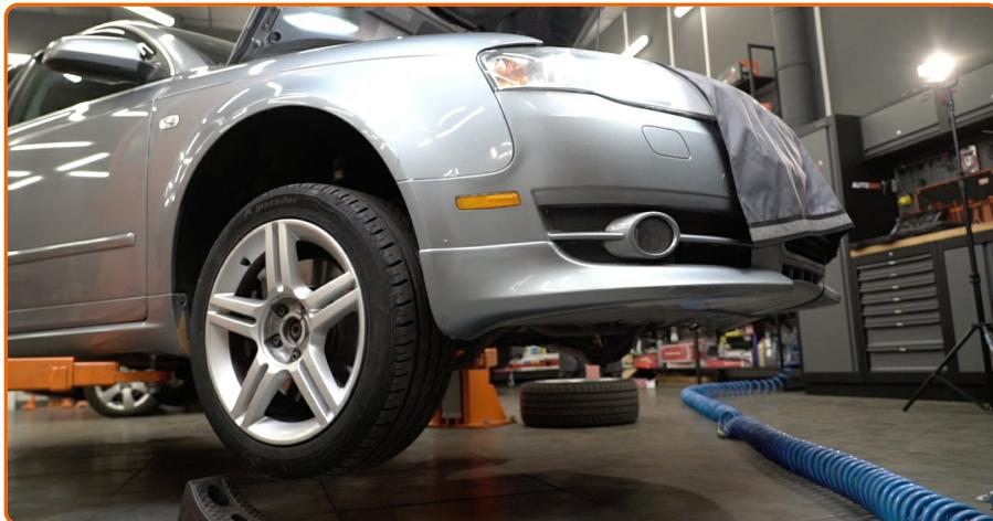
Heben Sie die Vorderseite des Autos und sichern auf Stützen.
