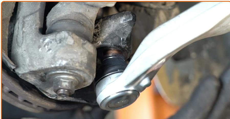
Verbinden Sie das Kugelgelenk mit dem Achsschenkel.
