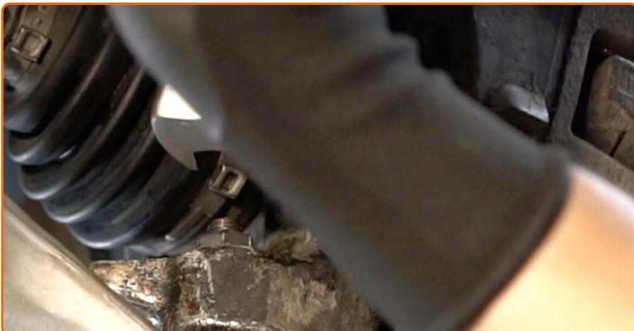
Ziehen Sie das Kugelgelenk an. Verwenden Sie Ring-Gabelschlüssel Nr. 18. Verwenden Sie einen Drehmomentschlüssel. Ziehen Sie ihn mit 60 Nm Drehmoment fest.
