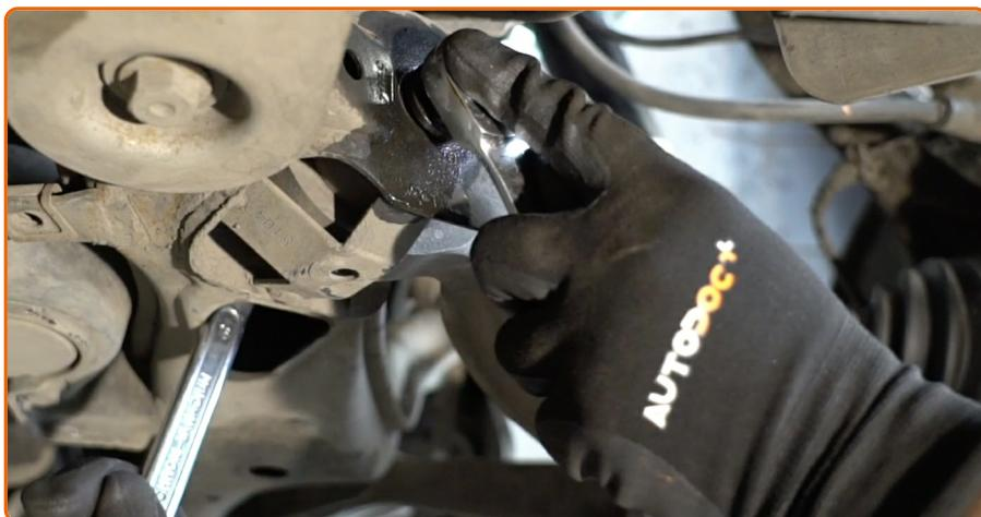
Schrauben Sie das hintere Befestigungselement heraus, das den Querlenker mit dem Hilfsrahmen verbindet. Verwenden Sie Ring-Gabelschlüssel Nr. 18 (2 Teile).
