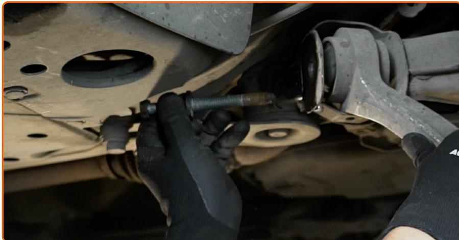
Entfernen Sie die Befestigungsschraube.
