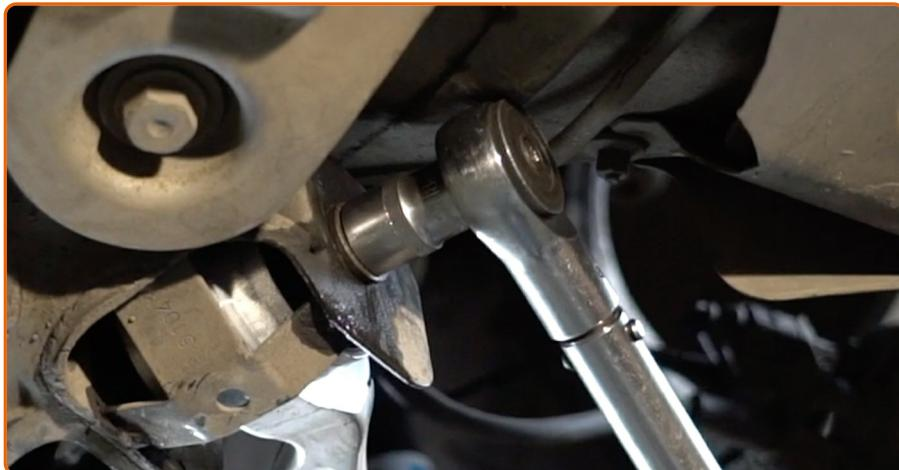
Schrauben Sie die hinteren Befestigungen, welche den Querlenker mit dem Karosseriehilfsrahmen verbinden, fest. Verwenden Sie Ring-Gabelschlüssel Nr. 18. Verwenden Sie Stecknuss Nr. 18. Verwenden Sie einen Drehmomentschlüssel. Ziehen Sie ihn mit 85 Nm Drehmoment fest.
