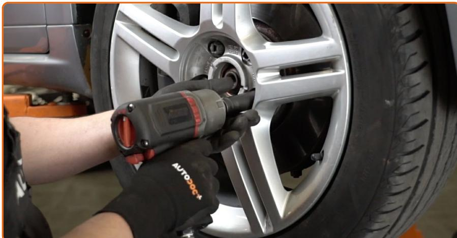
Schrauben Sie die Radbolzen fest. Verwenden Sie eine Schlagnuss für Felgen # 17.
