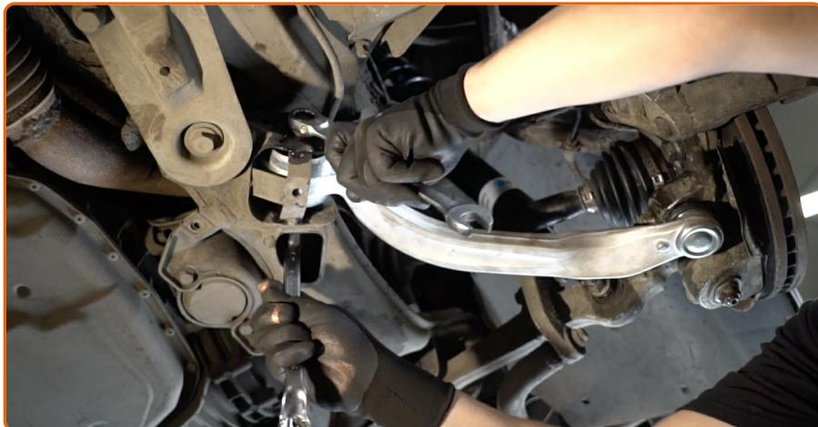
Schrauben Sie die hintere Armbefestigung an. Verwenden Sie Ring-Gabelschlüssel Nr. 18 (2 Teile).
