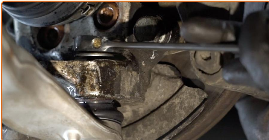
Schrauben Sie die Befestigungen des Kugelgelenks ein. Verwenden Sie Ring-Gabelschlüssel Nr. 18.
