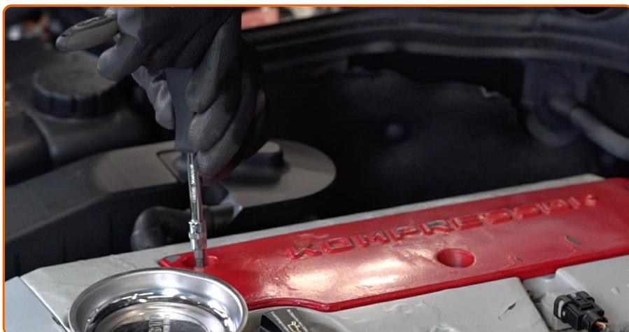
Lösen Sie die Schrauben der Motorabdeckung (3 Stück). Verwenden Sie Inbusschlüssel Nr. HW5.
