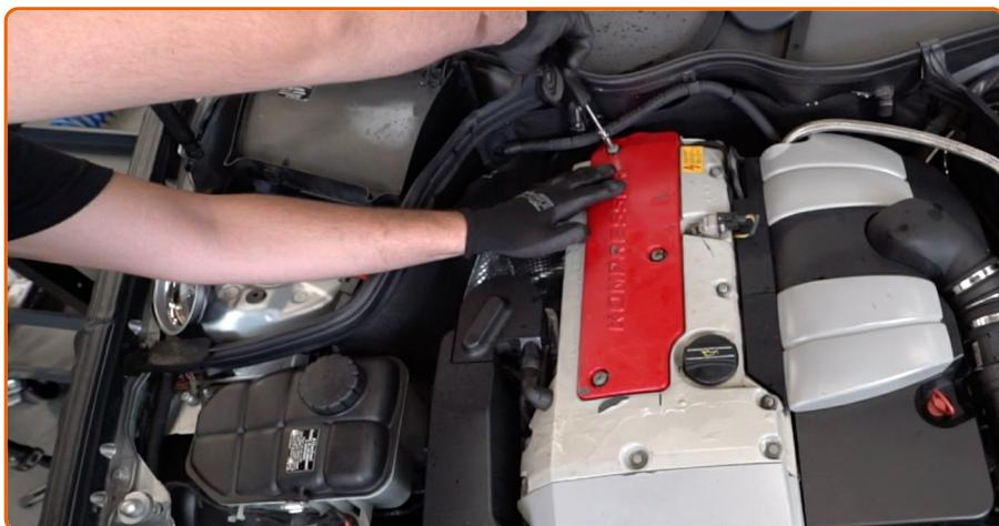
Installieren Sie die Motorabdeckung und sichern Sie diese. Verwenden Sie Inbusschlüssel Nr. HW5. Verwenden Sie einen Ratschenschlüssel.
