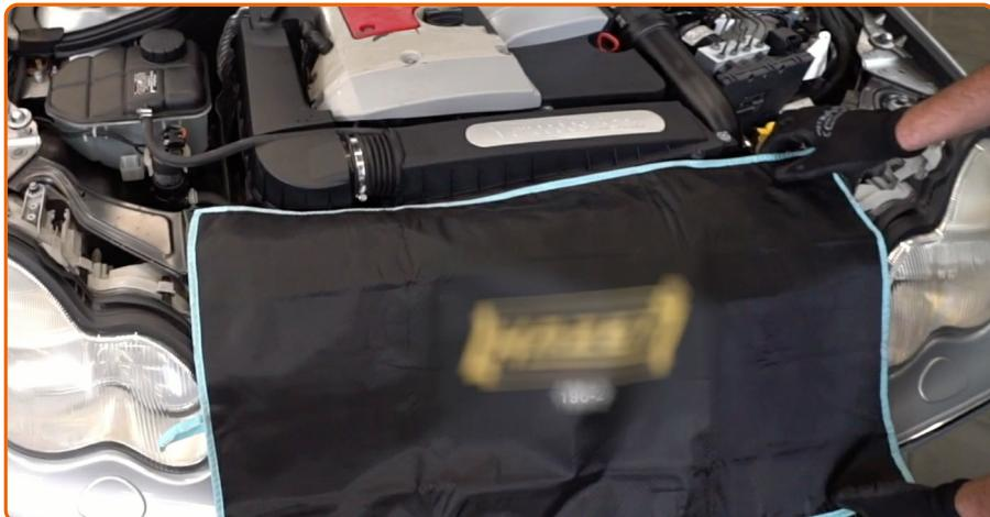
Entfernen Sie die Kotflügel-Abdeckung.
