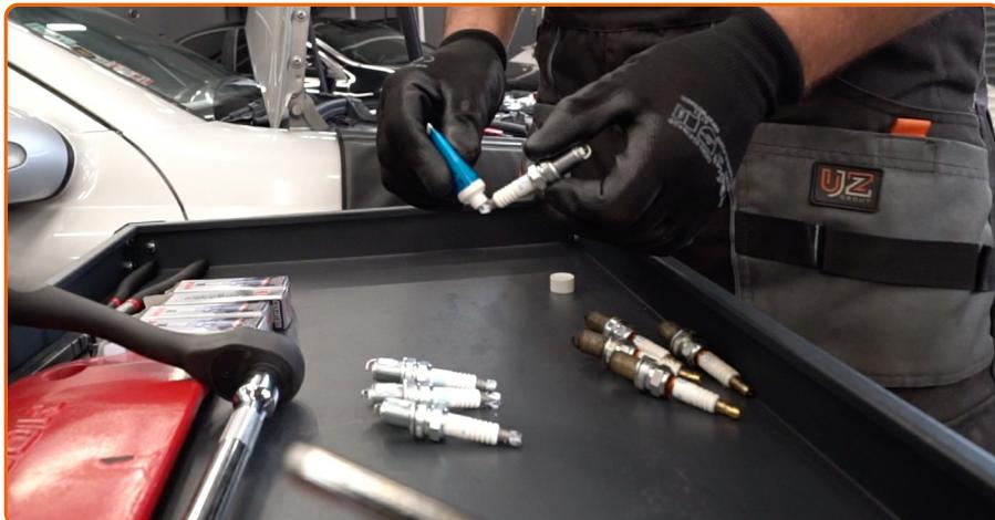
Tragen Sie eine dünne Schicht eines speziellen Hochtemperatur-Anti-Seize-Schmiermittels auf das Gewinde der neuen Zündkerzen auf. Behandeln Sie die Oberfläche der Anschlüsse der neuen Zündkerzen. Verwenden Sie Elektronikspray.
