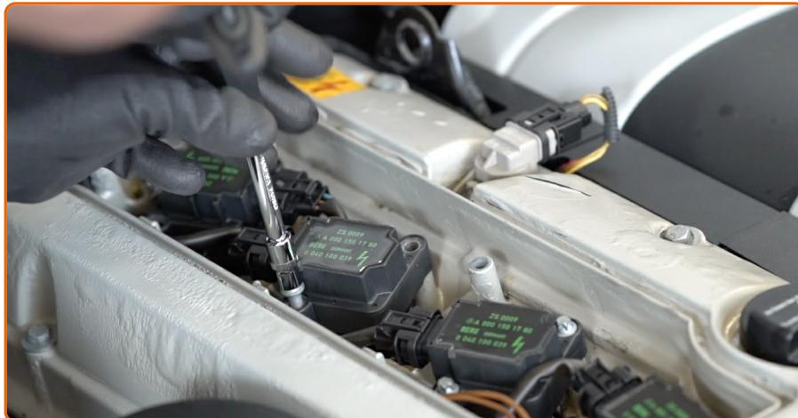
Schrauben Sie die Befestigungsschrauben der Zündspulen ab. Verwenden Sie Stecknuss Nr. E8.
