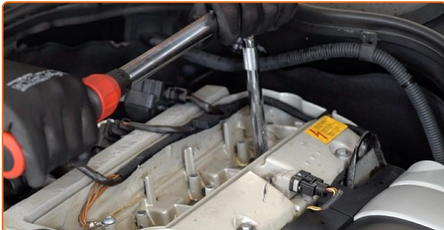
Schrauben Sie die neuen Zündkerzen an und ziehen Sie diese fest. Verwenden Sie die Zündkerzennuss # 16. Verwenden Sie einen Drehmomentschlüssel. Ziehen Sie ihn mit 25 Nm Drehmoment fest.
