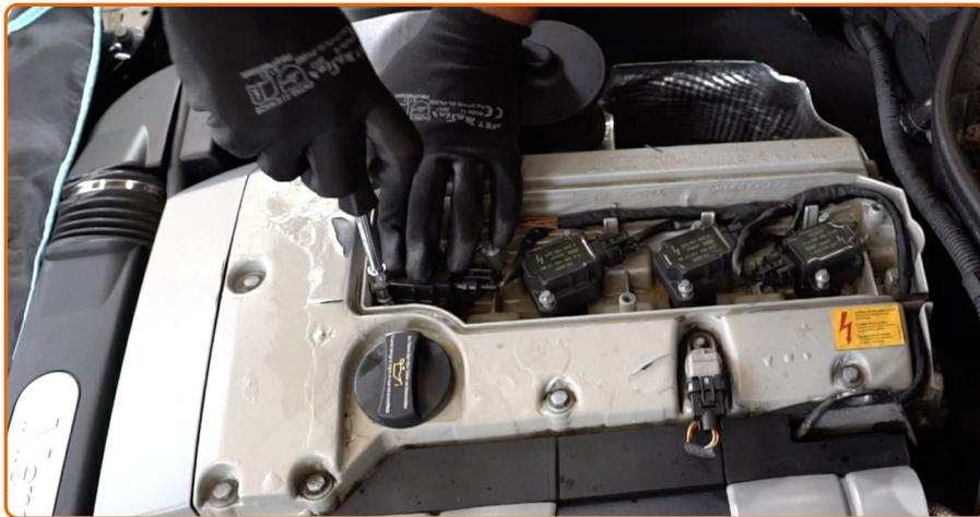
Ziehen Sie die Befestigungen der Zündspulen fest. Verwenden Sie Stecknuss Nr. E8. Verwenden Sie einen Drehmomentschlüssel. Ziehen Sie ihn mit 15 Nm Drehmoment fest.
