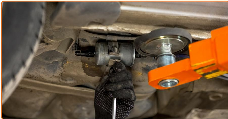
Ziehen Sie die Befestigungsmittel des Treibstofffilters fest. Verwenden Sie einen Kreuzschlitzschraubendreher.
