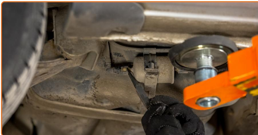
Drücken Sie die Clips zusammen und lösen Sie die Kraftstoffzufuhrleitungen vom Kraftstofffiltergehäuse. Verwenden Sie Kraftstoffleitungszangen.
