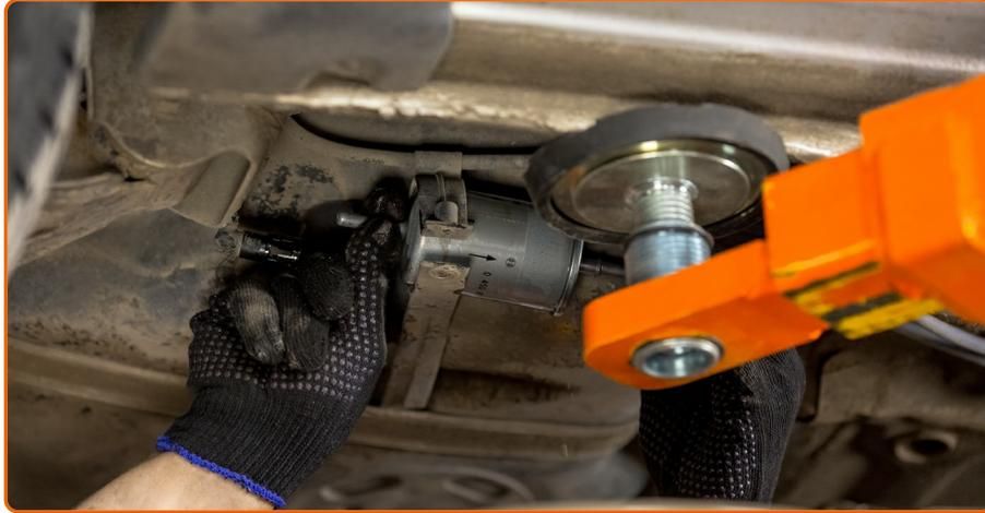
Installieren Sie einen neuen Kraftstofffilter.
