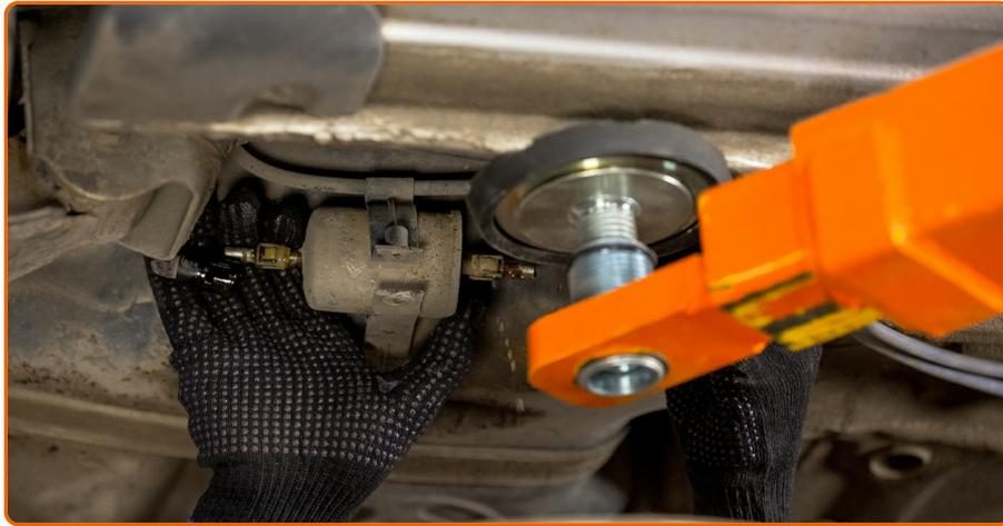
Entfernen Sie den Kraftstofffilter.
