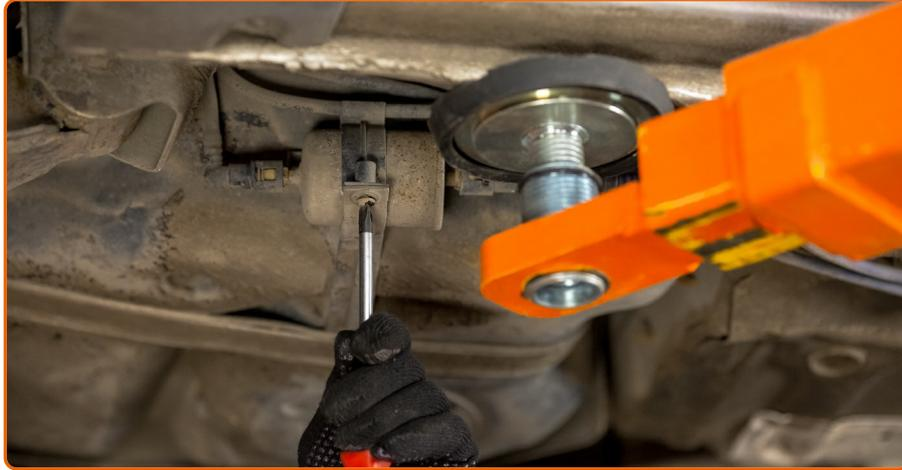
Lösen Sie die Filterbefestigungen. Verwenden Sie einen Kreuzschlitzschraubendreher.
