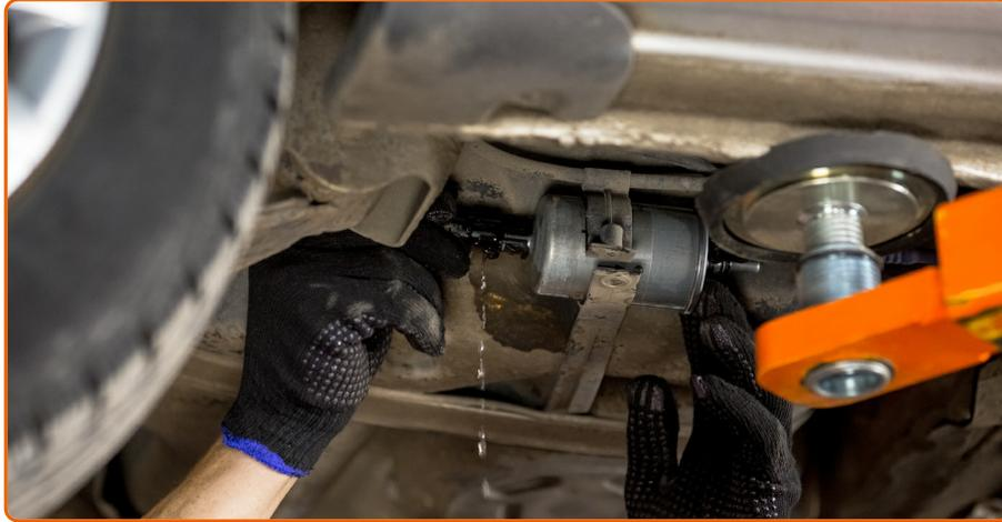
Verbinden Sie die Kraftstoffversorgungsleitungen zum Kraftstofffilter.
