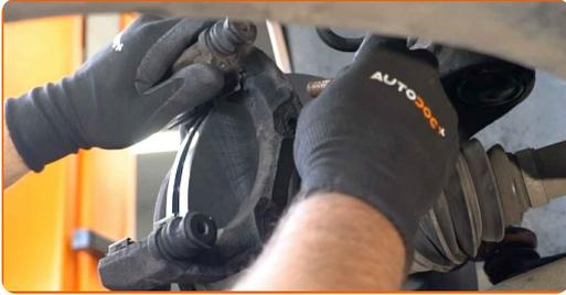
25 Befestigen Sie die Bremssattelhalterung. Verwenden Sie den Torx T55. Verwenden Sie einen Drehmomentschlüssel. Ziehen Sie ihn mit 105 Nm Drehmoment fest.
