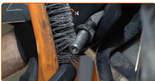
**13** Schrauben Sie einen neuen Spurstangenkopf an.
