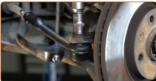
**17** Beim Deinstallieren sollten Sie die genaue Position des Kugelgelenks an der Spurstange markieren oder messen - oder zählen Sie die Anzahl der Windungen, um danach eine Fehlausrichtung zu vermeiden. Verwenden Sie einen Messschieber.
