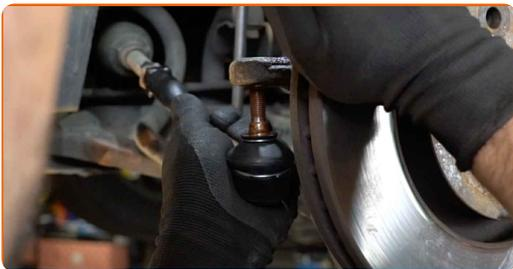
**15** Schrauben Sie die Befestigungsmutter auf, die den Spurstangenkopf mit dem Achsschenkel verbindet. Verwenden Sie Stecknuss Nr. 17. Verwenden Sie einen Ratschenschlüssel.
