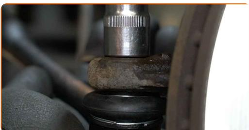
**16** Ziehen Sie die Befestigungsmutter an, die den Spurstangenkopf mit dem Achsschenkel verbindet. Verwenden Sie Stecknuss Nr. 17. Verwenden Sie einen Drehmomentschlüssel. Ziehen Sie ihn mit 35 Nm Drehmoment fest.
