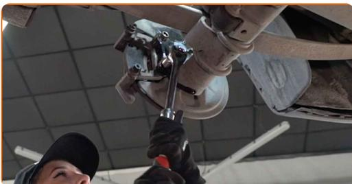
**13** Entfernen Sie den Bremssattelhalter.
