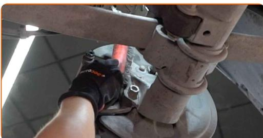
**12** Schrauben Sie die Befestigungen des Bremssattelhalters ab. Verwenden Sie Stecknuss Nr. 18. Verwenden Sie einen Ratschenschlüssel. Verwenden Sie ein Windeisen.
