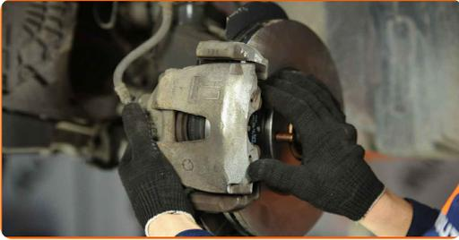
**31** Reinigen Sie die Bremssattel-Führungsstifte.
