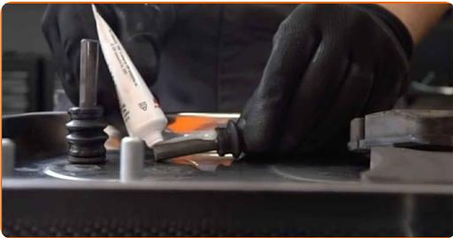
**33** Schrauben Sie die Führungsbolzen hinein.
