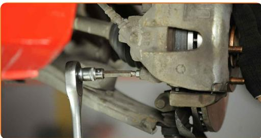
**35** Installieren Sie die Staubschutzkappen der Bremssattel-Führungsstifte.
