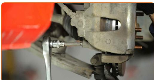
**11** Entfernen Sie die Führungsstifte aus dem Bremssattel.
