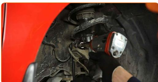
**8** Entfernen Sie die Halterung des ABS-Kabelbaums.
