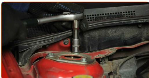
**36** Behandeln Sie die Befestigungselemente des Federbeinstützlagers. Benutzen Sie ein Kupferschmiermittel.
