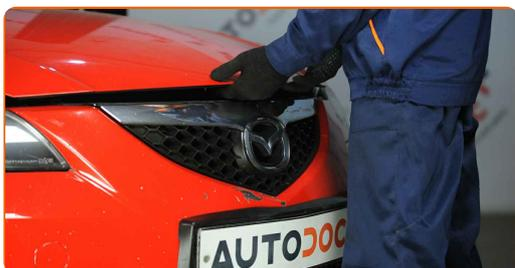
**19** Verwenden Sie eine Kotflügel-Schutzabdeckung, um Schäden an der Lackierung und den Kunststoffteilen des Autos zu verhindern.
