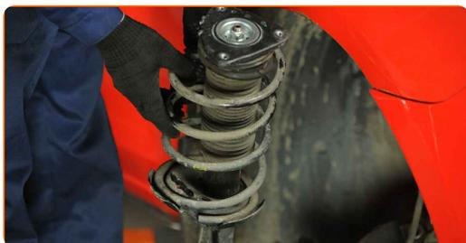
**34** Sichern Sie die oberen Befestigungen des Federbeines (3 Stück).
