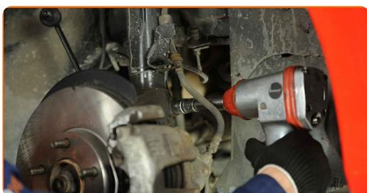
**14** Entfernen Sie die Befestigungsschraube.
