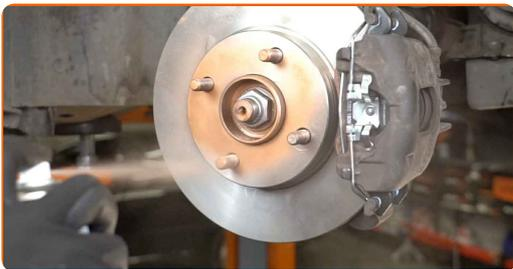
**52** Die Bremsscheibenoberfläche reinigen. Benutzen Sie einen Bremsenreiniger.
