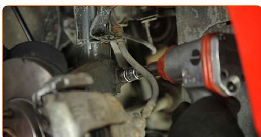
**44** Befestigen Sie den Bremsschlauch an der Strebe.
