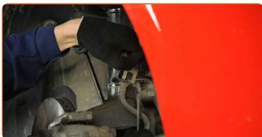
**11** Lösen Sie den Bremsschlauch vom Federbein.
