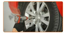
Senken Sie das Auto und ziehen Sie die Radschrauben über Kreuz an. Verwenden Sie eine Schlagnuss für Felgen # 19. Verwenden Sie einen Drehmomentschlüssel. Ziehen Sie ihn mit 118 Nm Drehmoment fest.
