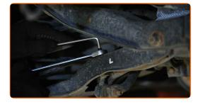
Entfernen Sie die Befestigungsschraube.
