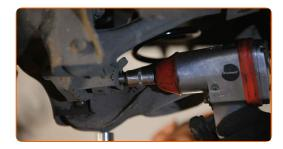
Entfernen Sie den Träger unter dem Arm.
