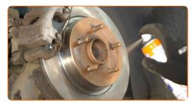
Die Bremsscheibenoberfläche reinigen. Benutzen Sie einen Bremsenreiniger.
