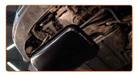
Drehen Sie die Ablassschraube heraus. Verwenden Sie Stecknuss Nr. 19. Verwenden Sie einen Ratschenschlüssel.
