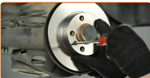
**20** Säubern Sie die Halterung des Bremssattels. Benutzen Sie eine Drahtbürste. Benutzen Sie einen Bremsenreiniger.
