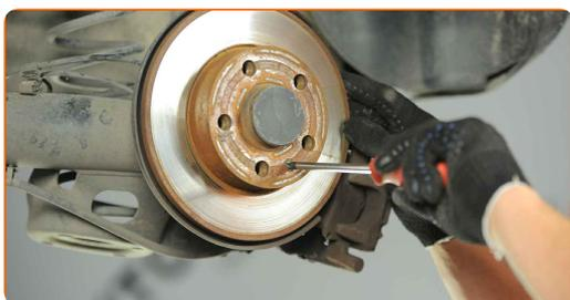
**16** Entfernen Sie die Bremsscheibe.
