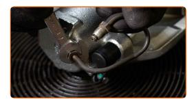
Schrauben Sie die Befestigungen der Bremsschlauchhalterung ein. Verwenden Sie Ring-Gabelschlüssel Nr. 10.
