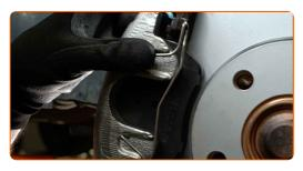
Behandeln Sie den Bremsschlauch. Benutzen Sie einen Bremsenreiniger.
