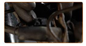
Entfernen Sie die Klammer des Bremsschlauchs.
