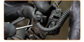
Trennen Sie den Bremsbelag Verschleißsensor. Benutzen Sie ein Brecheisen.
