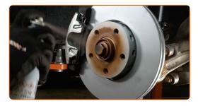
Die Bremsscheibenoberfläche reinigen. Benutzen Sie einen Bremsenreiniger.
