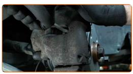
Reinigen Sie den Bereich, in welchem der Bremsschlauch an den Bremssattel angeschlossen ist, sowie den Bereich der Führungsbolzen. Benutzen Sie eine Drahtbürste. Benutzen Sie einen Bremsenreiniger.
