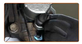
Bauen Sie die Halteklammer des Bremsbelags ein. Benutzen Sie ein Brecheisen.
