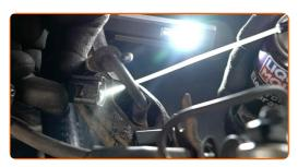
Verbinden Sie den Bremsbelag-Verschleiß-Sensor.
