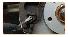
Entfernen Sie den Bremssattel.
