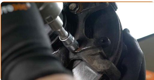
**17** Entfernen Sie die Sattelhalterung.
