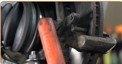
**16** Lösen Sie die Befestigung der Sattelhalter. Verwenden Sie Stecknuss Nr. 17. Verwenden Sie ein Windeisen. Verwenden Sie einen Ratschenschlüssel.
