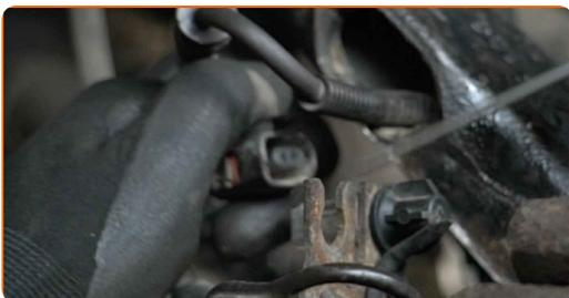
**11** Trennen Sie den Bremsbelag Verschleißsensor. Benutzen Sie ein Brecheisen.
