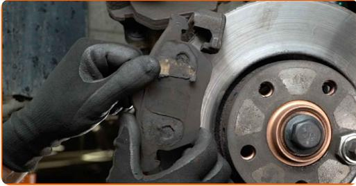
**15** Entfernen Sie Schmutz und Staub vom Bremssattelhalter. Benutzen Sie eine Drahtbürste. Benutzen Sie WD-40-Spray.
