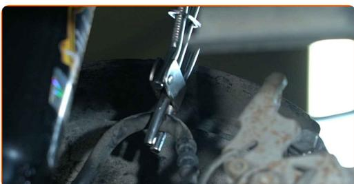
**11** Lösen Sie die Bremsschlauchbefestigung. Verwenden Sie Ring-Gabelschlüssel Nr. 13.
