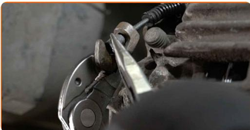
**9** Reinigen Sie den Bereich, in welchem der Bremsschlauch an den Bremssattel angeschlossen ist, sowie den Bereich der Führungsbolzen. Benutzen Sie eine Drahtbürste. Benutzen Sie einen Bremsenreiniger.
