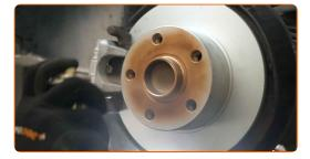
Die Bremsscheibenoberfläche reinigen. Benutzen Sie einen Bremsenreiniger.
