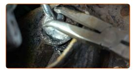
Reinigen Sie das Befestigungselement der Radnabe. Benutzen Sie eine Drahtbürste. Benutzen Sie WD-40-Spray.
