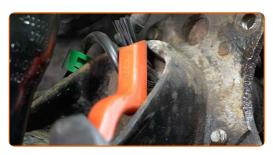
Lösen Sie die Befestigung des ABS-Sensors. Verwenden Sie einen flachen Schraubendreher.
