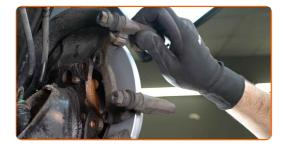
Befestigen Sie die Bremssattelhalterung. Verwenden Sie Inbusschlüssel Nr. H8. Verwenden Sie einen Drehmomentschlüssel. Ziehen Sie ihn mit 95 Nm Drehmoment fest.
