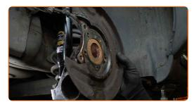
Schrauben Sie die Schrauben der Radnabe fest. Verwenden Sie Inbusschlüssel Nr. H8. Verwenden Sie einen Drehmomentschlüssel. Ziehen Sie ihn mit 60 Nm Drehmoment fest.
