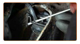
Lösen Sie den ABS-Sensor. Verwenden Sie eine Kneifzange.
