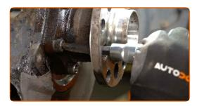
Entfernen Sie die Nabe und das Lager zusammen, da sie eine versiegelte Einheit sind.
