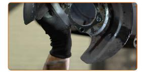
Reinigen Sie den Einbauort für die Nabenlagerung. Benutzen Sie eine Drahtbürste. Benutzen Sie WD-40-Spray.
