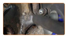
Lösen Sie die Befestigung der Sattelhalterung. Verwenden Sie Inbusschlüssel Nr. H8. Verwenden Sie ein Windeisen. Verwenden Sie einen Ratschenschlüssel.
