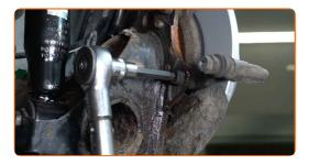
Verbinden Sie den ABS-Sensor. Verwenden Sie eine Kneifzange.
