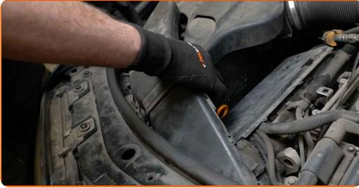
17 Schraube die Befestigungselemente des Lüftungskanals ein. Verwenden Sie einen Kreuzschlitzschraubendreher.
