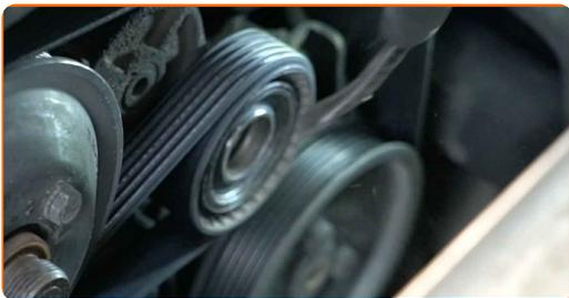
**10** Ziehen Sie die Spannrolle des Keilrippenriemens beiseite. Verwenden Sie Stecknuss Nr. 16. Verwenden Sie einen Ratschenschlüssel.
