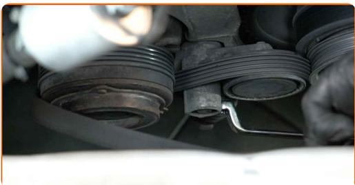
**9** Entfernen Sie die Spannrollenschutzhülle.
