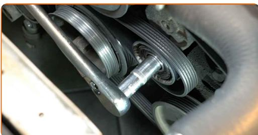
**11** Entfernen Sie den Keilrippenriemen.
