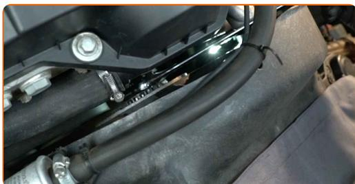
**4** Entfernen Sie die Gummileiste der Lüfterzarge.
