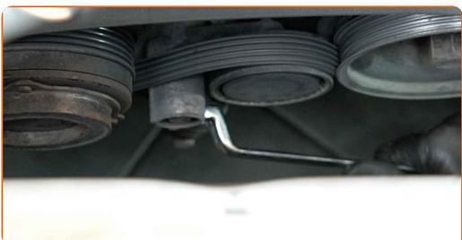
**8** Entfernen Sie den A/C-Kompressorriemen.
