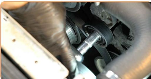
**12** Bringen Sie die Spannrolle zurück in ihre ursprüngliche Position. Verwenden Sie Stecknuss Nr. 16. Verwenden Sie einen Ratschenschlüssel.
