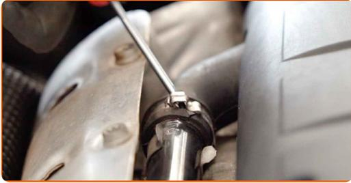
**5** Schrauben Sie das Verbindungsteil der Motorhaube ab. Verwenden Sie Stecknuss Nr. 10. Verwenden Sie einen Ratschenschlüssel.
