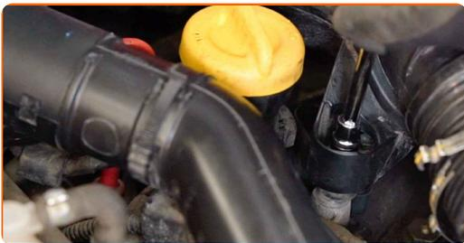
**32** Verbinden Sie das Luftansaugrohr mit dem Luftfilter-Gehäuse.
