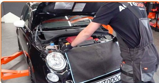
**3** Lösen Sie die Luftansaugschlauchklemme. Verwenden Sie einen flachen Schraubendreher.
