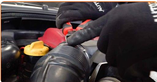
**34** Ziehen Sie die Klemme am Kurbelgehäuse-Entlüftungsschlauch an. Verwenden Sie Kombinationszangen.
