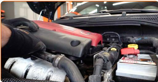
**8** Trennen Sie den Schlauch der Kurbelgehäuseentlüftung vom Lüftungsrohr.
