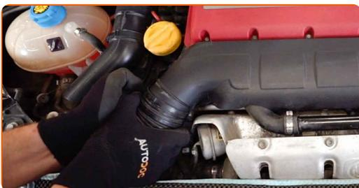
**33** Ziehen Sie die Klemme am Luftansaugschlauch fest. Verwenden Sie Kombinationszangen.
