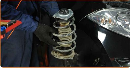
**32** Installieren Sie das Federbein am Radlauf.
