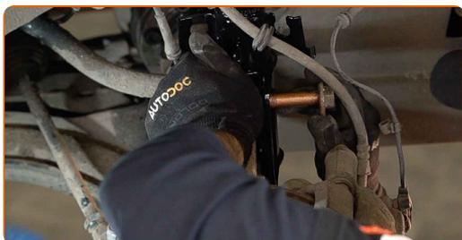
**38** Ziehen Sie die unteren Befestigungen an, die das Federbein mit dem Achsschenkel verbinden. Verwenden Sie Ring-Gabelschlüssel Nr. 21. Verwenden Sie Stecknuss Nr. 21. Verwenden Sie einen Drehmomentschlüssel. Ziehen Sie ihn mit 120 Nm Drehmoment fest.+90°
