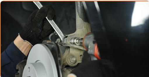
**13** Entfernen Sie die Befestigungsschrauben.
