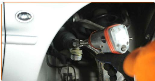
**19** Entfernen Sie die Befestigungsschraube.
