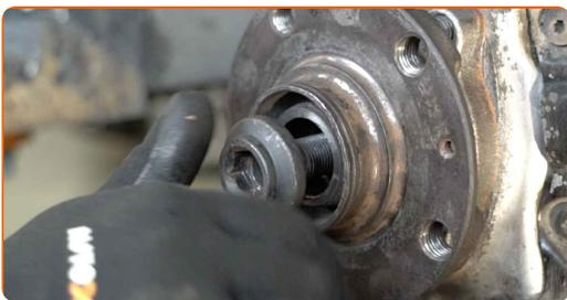
**43** Ziehen Sie die Nabe hindurch. Verwenden Sie Stecknuss Nr. 24. Verwenden Sie einen Drehmomentschlüssel. Ziehen Sie ihn mit 115 Nm Drehmoment fest.+180°
