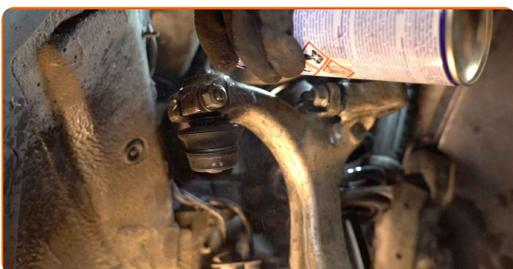
**18.1** Lösen Sie das Ende der Befestigungsmutter an dem Achsschenkel.
