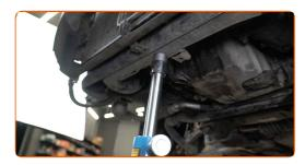
Ziehen Sie die Verbindungselemente des Bewehrungsstabs des Stoßfängers an. Verwenden Sie Stecknuss Nr. 13. Verwenden Sie einen Drehmomentschlüssel. Halten Sie das empfohlene Anzugsdrehmoment ein.
