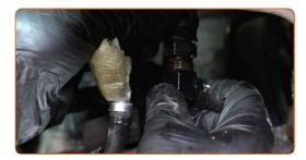
Schrauben Sie die Befestigung des Schlauchs der Ölkühlleitung des Automatikgetriebes fest. Verwenden Sie Ring-Gabelschlüssel Nr. 19. Verwenden Sie Ring-Gabelschlüssel Nr. 22. Verwenden Sie einen Drehmomentschlüssel. Halten Sie das empfohlene Anzugsdrehmoment ein.
