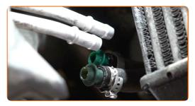
Reinigen Sie die Rohre der Ölkühlleitung des Automatikgetriebes. Verwenden Sie Allzweckreinigungsspray.
