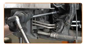
Entfernen Sie die Stütze unter dem Bewehrungsstabs des Stoßfängers.
