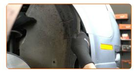
Schrauben Sie das Verbindungselement des Abstandshalters unter dem Bewehrungsstab des Stoßfängers ab. Verwenden Sie den Torx T25. Verwenden Sie Stecknuss Nr. 10. Verwenden Sie einen Ratschenschlüssel.
