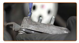
Bauen Sie die Spannrolle des Keilrippenriemens ein.
