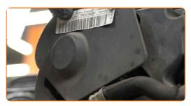
Ziehen Sie die Spannrolle des Keilrippenriemens beiseite. Verwenden Sie Ring-Gabelschlüssel Nr. 17.
