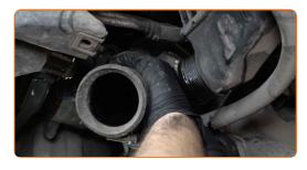
Decken Sie die Luftführung des Ladeluftkühlers mit einem Mikrofasertuch ab um zu verhindern, dass Dreck und Fremdkörper in das System gelangen.
