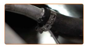
Entfernen Sie die Rohre der Ölkühlleitung des Automatikgetriebes.
