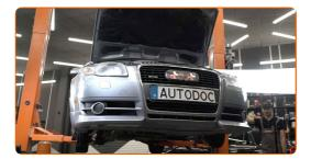
Schrauben Sie die oberen Verbindungselemente des Stoßfängers ab und entfernen Sie sie. Verwenden Sie den Torx T27. Verwenden Sie Stecknuss Nr. 10. Verwenden Sie einen Ratschenschlüssel.
