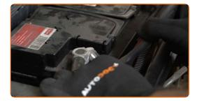
Entfernen Sie die Batterieklemmen.
