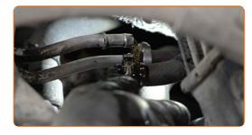
Verschließen Sie die Rohre der Ölkühlleitung des Automatikgetriebes mit Verschlüssen.
