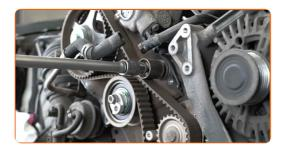
Entfernen Sie die Umlenkriemenscheibe des Zahnriemens aus ihrer Montageposition.
