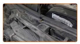
60 Entfernen Sie den Luftansaugkanal.
