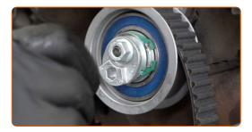
Behandeln Sie die Befestigungsschraube. Verwenden Sie ein Dichtmittel.
