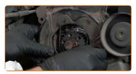
Schrauben Sie die Befestigungen der unteren Zahnriemenabdeckung fest. Verwenden Sie Stecknuss Nr. 10. Verwenden Sie einen Drehmomentschlüssel. Ziehen Sie ihn mit 10 Nm Drehmoment fest.
