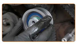
Behandeln Sie die Befestigungsschraube. Verwenden Sie ein Dichtmittel.
