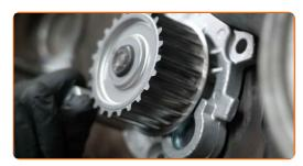
Schrauben Sie die Befestigungen der Wasserpumpe ein. Verwenden Sie Stecknuss Nr. 10. Verwenden Sie einen Ratschenschlüssel.
