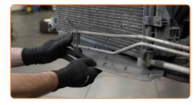
Schrauben Sie die Befestigungen der Leitungen der hydraulischen Servolenkung ab. Verwenden Sie den Torx T20. Verwenden Sie den Torx T27. Verwenden Sie einen Ratschenschlüssel.
