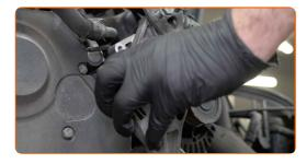
Schrauben Sie die Befestigung der Klemme des Kühlmittelschlauchs ab. Verwenden Sie Inbusschlüssel Nr. H6. Verwenden Sie einen Ratschenschlüssel.
