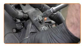
Entfernen Sie die Spannrolle des Keilrippenriemens.
