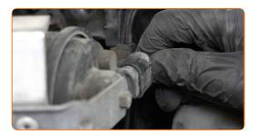
Bringen Sie die Verkabelung des Kühlmitteltemperatursensors an.
