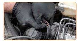
Lösen Sie den Stecker des Motorkühlgebläses.
