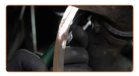
Lassen Sie das Kühlmittel aus dem Motor ab.
