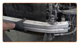
Schrauben Sie die Befestigungen des Bewehrungsstabs des Stoßfängers ein. Verwenden Sie Stecknuss Nr. 13. Verwenden Sie einen Ratschenschlüssel.
