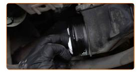
Lösen Sie die Luftansaugschlauchklemme. Verwenden Sie Stecknuss Nr. 7. Verwenden Sie einen Ratschenschlüssel.
