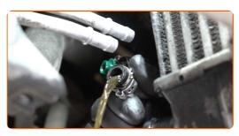
Bringen Sie die Leitungen der hydraulischen Servolenkung an.
