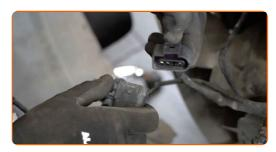
Lösen Sie Leitung der Scheinwerferwaschanlage.
