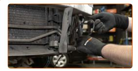
Schrauben Sie die Verbindungselemente des Bewehrungsstab des Stoßfängers ab. Verwenden Sie Stecknuss Nr. 13. Verwenden Sie einen Ratschenschlüssel.
