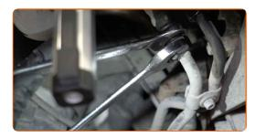
Lösen Sie den Schlauch der Ölkühlleitung des Automatikgetriebes.
