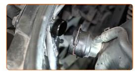
Entfernen Sie die Motorhaubendichtung.
