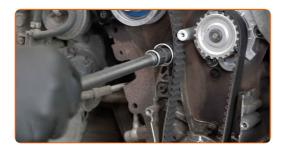
Stellen Sie die Spannung des Zahnriemens durch Bewegung der Spannrolle ein. Verwenden Sie Ring-Gabelschlüssel Nr. 13. Verwenden Sie Inbusschlüssel Nr. H6.
