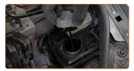
Füllen Sie den Behälter der hydraulischen Servolenkung mit Flüssigkeit.
