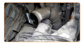
Decken Sie die Luftführung des Ladeluftkühlers mit einem Mikrofasertuch ab um zu verhindern, dass Dreck und Fremdkörper in das System gelangen.
