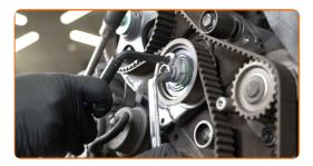
Schraube die Befestigung der Umlenkriemenscheibe des Zahnriemens ab. Verwenden Sie Stecknuss Nr. 13. Verwenden Sie einen Ratschenschlüssel.
