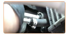
Schrauben Sie die Befestigungen der Leitungen der hydraulischen Servolenkung ein. Verwenden Sie den Torx T20. Verwenden Sie den Torx T27. Verwenden Sie einen Ratschenschlüssel.
