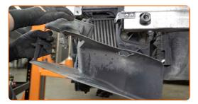
Lösen Sie den Steckverbinder der Hupe.
