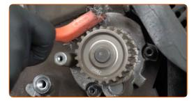
Schrauben Sie die Befestigungen der Wasserpumpe ab. Verwenden Sie Stecknuss Nr. 10. Verwenden Sie einen Ratschenschlüssel.
