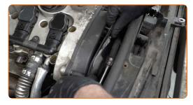
Schrauben Sie die Befestigungen der vorderen oberen Zahnriemenabdeckung ein. Verwenden Sie einen flachen Schraubendreher.
