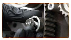
Entfernen Sie die Spannrolle des Zahnriemens.
