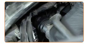
Bringen Sie den Clip des oberen Kühlmittelschlauchs an.
