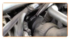
Lösen Sie den oberen Kühlmittelschlauch.
