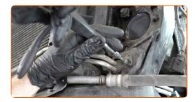
Entfernen Sie das Mikrofasertuch von der Luftführung des Ladeluftkühlers.
