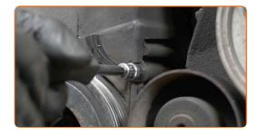
Entfernen Sie die Zahnriemenabdeckung.
