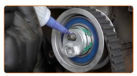
Schraube die Befestigung der Spannrolle des Zahnriemens ein. Verwenden Sie Stecknuss Nr. 13. Verwenden Sie einen Ratschenschlüssel.
