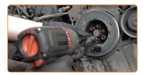
Drehen Sie das Kurbelwellenrad. Verwenden Sie die 12-Kant-Stecknuss Nr. 19. Verwenden Sie ein Windeisen.
