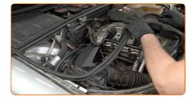
Schrauben Sie die Befestigungen des Klimakühlers ab. Verwenden Sie den Torx T27. Verwenden Sie einen Ratschenschlüssel.
