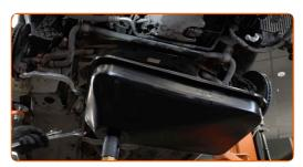
Lockern Sie die Befestigung des Schlauchs der Ölkühlleitung des Automatikgetriebes. Verwenden Sie Ring-Gabelschlüssel Nr. 19. Verwenden Sie Ring-Gabelschlüssel Nr. 22.
