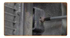
Entfernen Sie die Kühlerluftführungen.
