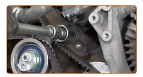
Schrauben Sie die Befestigung der Umlenkriemenscheibe des Zahnriemens fest. Verwenden Sie Stecknuss Nr. 12. Verwenden Sie einen Drehmomentschlüssel. Ziehen Sie ihn mit 25 Nm Drehmoment fest.
