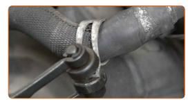
Schrauben Sie die Befestigung der Klemme des Kühlmittelschlauchs ein. Verwenden Sie Inbusschlüssel Nr. H6. Verwenden Sie einen Ratschenschlüssel.
