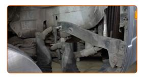
Lösen Sie die Seitenclips des Stoßfängers. Lösen Sie den Stoßfänger vorsichtig von den Verbindungselementen.
