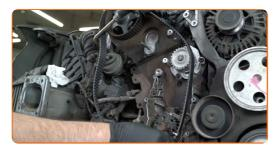
Austausch: Zahnriemensatz mit Wasserpumpe – Audi A4 B7. Tipp:
