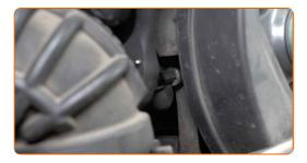
Lockern Sie die Klemme des Kühlmittelschlauchs. Verwenden Sie eine Clic-R-Kragenzange.
