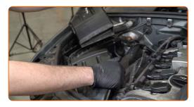
Lösen Sie den Stecker des Motorkühlgebläses.
