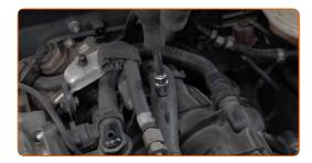
Schrauben Sie den Deckel des Behälters der hydraulischen Servolenkung ab. Entfernen Sie den Deckel vom Behälter der hydraulischen Servolenkung.
