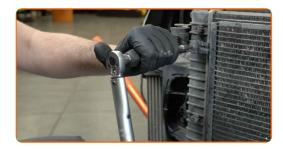
150 Entfernen Sie den Träger unter dem Motor.
