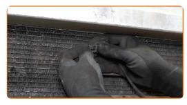
Lösen Sie die Verkabelung des Kühlmitteltemperatursensors. Verwenden Sie einen flachen Schraubendreher.
