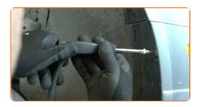
11 Entfernen Sie die Radkastenabdeckung.
