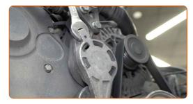
78 Entfernen Sie den Keilrippenriemen.
