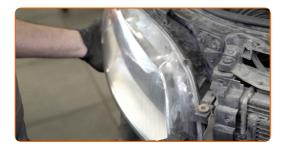
Schrauben Sie Scheinwerfer-Befestigungen ein. Verwenden Sie den Torx T27. Verwenden Sie einen Ratschenschlüssel.
