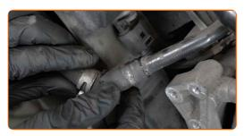
Sichern Sie die Klemme des Kühlmittelschlauchs. Verwenden Sie eine Clic-R-Kragenzange.
