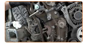
Reinigen Sie die Befestigungen der Wasserpumpe. Benutzen Sie eine Drahtbürste. Verwenden Sie Allzweckreinigungsspray.
