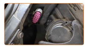
Lösen Sie den Steckverbinder der Hupe.
