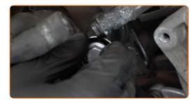
Schrauben Sie die Befestigung der Zahnriemenspannrolle ein. Verwenden Sie Stecknuss Nr. 13. Verwenden Sie einen Ratschenschlüssel.
