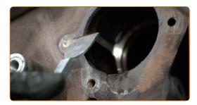
Reinigen Sie die Wasserpumpe. Verwenden Sie Allzweckreinigungsspray.
