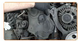
Schrauben Sie die Befestigungen der Zahnriemenabdeckung fest. Verwenden Sie Stecknuss Nr. 10. Verwenden Sie den Torx T27. Verwenden Sie einen Drehmomentschlüssel. Ziehen Sie ihn mit 10 Nm Drehmoment fest.
