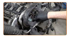
Reinigen Sie die Befestigungen der Kurbelwellenriemenscheibe. Benutzen Sie eine Drahtbürste. Benutzen Sie WD-40-Spray.
