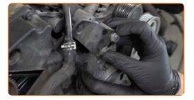
Schrauben Sie die Befestigung der Spannrolle des Keilrippenriemens fest. Verwenden Sie Stecknuss Nr. 13. Verwenden Sie einen Drehmomentschlüssel. Ziehen Sie ihn mit 23 Nm Drehmoment fest.
