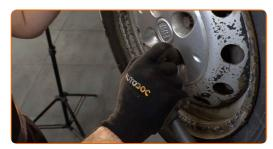
Senken Sie das Auto und ziehen Sie die Radschrauben über Kreuz an. Verwenden Sie einen Drehmomentschlüssel. Ziehen Sie ihn mit 98 Nm Drehmoment fest.
