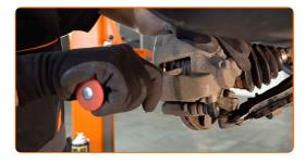
Entfernen Sie den Bremssattel.
