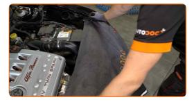
Entfernen Sie die Haltefeder des Luftfiltergehäuses.
