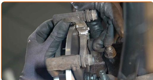
**24** Befestigen Sie die Bremssattelhalterung. Verwenden Sie Ring-Gabelschlüssel Nr. 17. Verwenden Sie einen Drehmomentschlüssel. Ziehen Sie ihn mit 55 Nm Drehmoment fest.
