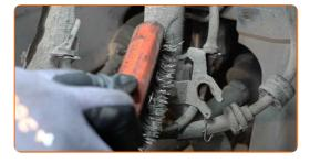
Trennen Sie die ABS Sensorverdrahtung.
