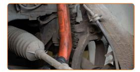
Schrauben Sie die Befestigungsmutter heraus, die die Koppelstange an der Stoßdämpfergabel befestigt. Verwenden Sie Stecknuss Nr. 17. Verwenden Sie einen Ratschenschlüssel.
