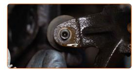
Ziehen Sie die Befestigungselemente des Stabilenkers fest. Verwenden Sie Stecknuss Nr. 17. Verwenden Sie einen Ratschenschlüssel.
