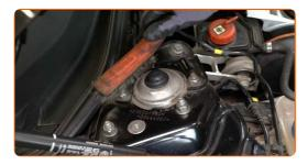
Schrauben Sie das obere Befestigungselement des Federbeins ab. Verwenden Sie Stecknuss Nr. 17. Verwenden Sie einen Ratschenschlüssel.
