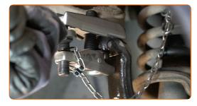
Entfernen Sie die Befestigungsschraube.
