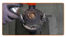
Entfernen Sie das zusammengebaute Federbein.
