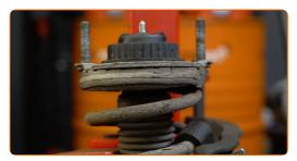
Entfernen Sie die Stangenmutter des Federkolben. Verwenden Sie einen Stoßdämpfer Steckschlüsseleinsatz DDNº6 Verwenden Sie Stecknuss Nr. 17. Verwenden Sie einen Ratschenschlüssel.
