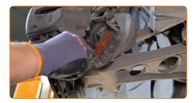
Schrauben Sie die Befestigungsschraube heraus, die die Stoßdämpfergabel mit dem unteren Querlenker verbindet. Verwenden Sie Ring-Gabelschlüssel Nr. 19. Verwenden Sie Stecknuss Nr. 19. Verwenden Sie einen Ratschenschlüssel.
