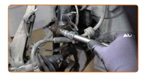
Entfernen Sie die Befestigungsschraube.
