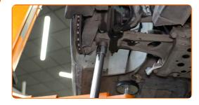
Ziehen Sie die Befestigungsschraube an, die die Stoßdämpfergabel mit dem unteren Querlenker verbindet. Verwenden Sie Ring-Gabelschlüssel Nr. 19. Verwenden Sie Stecknuss Nr. 19. Verwenden Sie einen Drehmomentschlüssel. Ziehen Sie ihn mit 110 Nm Drehmoment fest.
