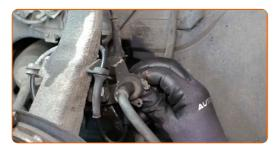
Den Halteclip des Bremsschlauchs anbringen.
