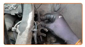
Befestigen Sie den Bremsschlauch an der Strebe.
