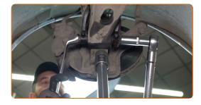
Entfernen Sie den Träger unter dem Arm.
