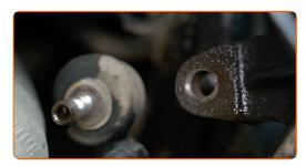
Reinigen Sie die Befestigungsschraube, die die Stoßdämpfergabel mit dem unteren Querlenker verbindet. Benutzen Sie eine Drahtbürste. Benutzen Sie WD-40-Spray.
