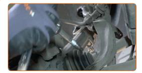
Reinigen Sie das Befestigungselement, das die Stoßdämpfergabel am Federbein befestigt. Benutzen Sie eine Drahtbürste. Benutzen Sie WD-40-Spray.
