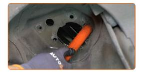
Installieren Sie das Federbein am Radlauf.
