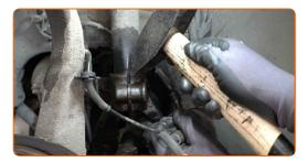
Entfernen Sie das zusammengebaute Federbein.
