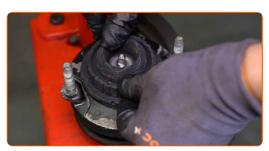
Ziehen Sie die Federbeinkolbenstangenmutter an. Verwenden Sie einen Stoßdämpfer Steckschlüsseleinsatz DDNº6 Verwenden Sie Stecknuss Nr. 16. Verwenden Sie einen Drehmomentschlüssel. Ziehen Sie ihn mit 35 Nm Drehmoment fest.
