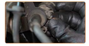
Ziehen Sie die Befestigungsschraube an, die das Federbein mit der Stoßdämpfergabel verbindet. Verwenden Sie Stecknuss Nr. 18. Verwenden Sie einen Drehmomentschlüssel. Ziehen Sie ihn mit 85 Nm Drehmoment fest.
