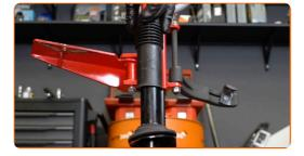
Installieren Sie die Feder am Stoßdämpfer.
