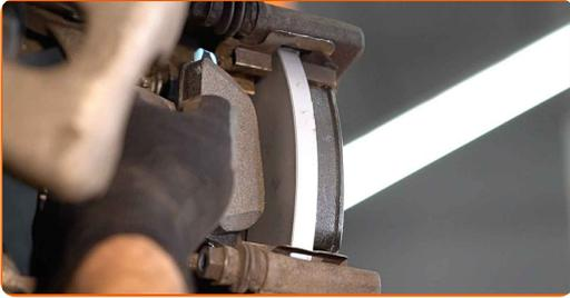
**33** Installieren Sie den Bremssattel und fixieren Sie diesen. Verwenden Sie Ring-Gabelschlüssel Nr. 13. Verwenden Sie Ring-Gabelschlüssel Nr. 15. Verwenden Sie Stecknuss Nr. 13. Verwenden Sie einen Drehmomentschlüssel. Ziehen Sie ihn mit 35 Nm Drehmoment fest.
