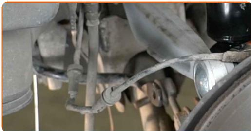
**22** Entfernen Sie den Träger unter dem Arm.
