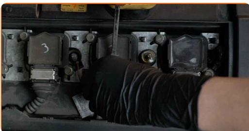
**11** Schrauben Sie die Befestigungsschrauben der Zündspulen ab. Verwenden Sie Stecknuss Nr. 10. Verwenden Sie einen Ratschenschlüssel.
