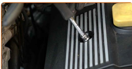
**7** Schrauben Sie die Öleinfüllschraube ab.
