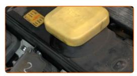
Lösen Sie die Steckverbindung von den Zündspulen. Benutzen Sie ein Brecheisen.
