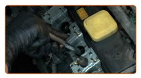
Schrauben Sie die neuen Zündkerzen an und ziehen Sie diese fest. Verwenden Sie die Zündkerzennuss # 16. Verwenden Sie einen Drehmomentschlüssel. Ziehen Sie ihn mit 26 Nm Drehmoment fest.
