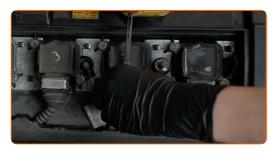
Schrauben Sie die Befestigungsschrauben der Zündspulen ab. Verwenden Sie Stecknuss Nr. 10. Verwenden Sie einen Ratschenschlüssel.
