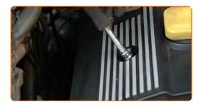
Schrauben Sie die Öleinfüllschraube ab.
