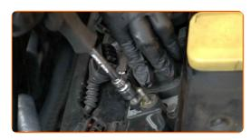
Ziehen Sie die Befestigungselemente der Zündspule fest. Verwenden Sie Stecknuss Nr. 10. Verwenden Sie einen Drehmomentschlüssel. Ziehen Sie ihn mit 11 Nm Drehmoment fest.
