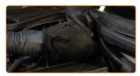
Schrauben Sie das Verbindungsteil der Motorhaube ab. Verwenden Sie Stecknuss Nr. 10. Verwenden Sie einen Ratschenschlüssel.
