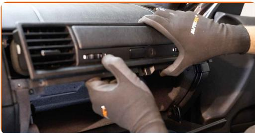
**5** Lösen Sie die Befestigungsschrauben des Handschuhfaches ab. Verwenden Sie einen Kreuzschlitzschraubendreher. Verwenden Sie einen flachen Schraubendreher.
