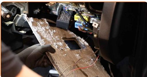
**12** Entfernen Sie den Gehäusedeckel des Innenraumfilters. Verwenden Sie einen Kreuzschlitzschraubendreher.
