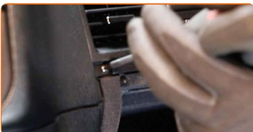
**4** Entfernen Sie das Lüftungsgitter.
