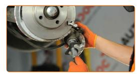
17.1 Installieren Sie den Bremssattel und fixieren Sie diesen.
