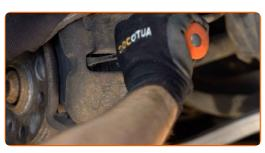
Entfernen Sie den Bremssattel.
