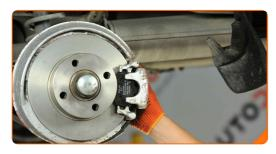
Verwenden Sie Ring-Gabelschlüssel Nr. 15. Verwenden Sie Ring-Gabelschlüssel Nr. 13. Verwenden Sie einen Drehmomentschlüssel. Ziehen Sie ihn mit 35 Nm Drehmoment fest.
