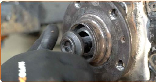
36 Ziehen Sie die Nabe hindurch. Verwenden Sie Stecknuss Nr. 24. Verwenden Sie einen Drehmomentschlüssel. Ziehen Sie ihn mit 200 Nm Drehmoment fest.+90°
