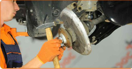
33 Befestigen Sie das Dämpferbein auf dem Achsschenkel.
