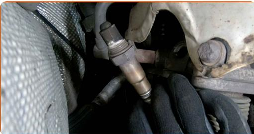
**9** Schneiden Sie das Gewinde für die neue Lambdasonde. Verwenden Sie einen Gewindebohrer. Verwenden Sie einen Ratschenschlüssel.
