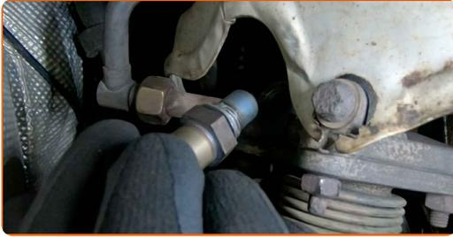
**12** Ziehen Sie die Befestigung der Lambdasonde fest. Verwenden Sie eine 22 mm Lambdasondenstecknuss. Verwenden Sie einen Drehmomentschlüssel. Ziehen Sie ihn mit 37 Nm Drehmoment fest.
