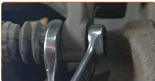
**9** Entfernen Sie die Befestigungsschrauben.
