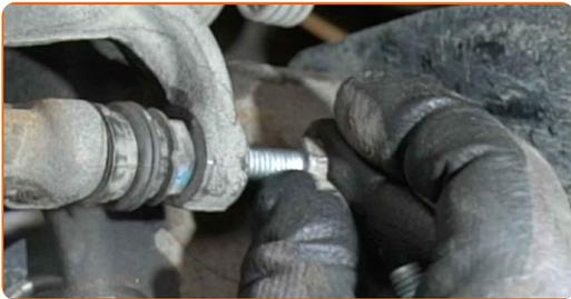
**19** Ziehen Sie die Bremssattelbefestigungen fest. Verwenden Sie Stecknuss Nr. 13. Verwenden Sie einen Drehmomentschlüssel. Ziehen Sie ihn mit 35 Nm Drehmoment fest.
