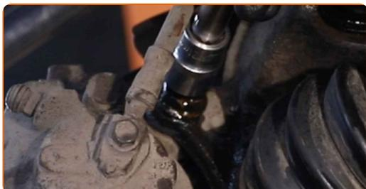
**11** Entfernen Sie die Befestigungsschrauben.
