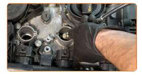
Tragen Sie eine dünne Schicht eines speziellen Hochtemperatur-Anti-Seize-Schmiermittels auf das Gewinde der neuen Zündkerzen auf.
