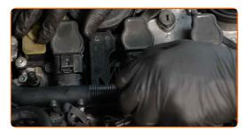
Schraube die Befestigungselemente der Zündspulen-Kabelführung ein. Verwenden Sie den Torx T30. Verwenden Sie einen Ratschenschlüssel.
