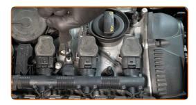
Lösen Sie die Steckverbindung von den Zündspulen.
