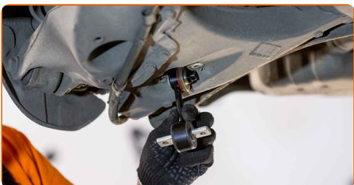
**12** Ziehen Sie das Befestigungselement an, das den Stabilisator mit dem Querlenker verbindet. Verwenden Sie Stecknuss Nr. 13. Verwenden Sie einen Drehmomentschlüssel. Ziehen Sie ihn mit 25 Nm Drehmoment fest.
