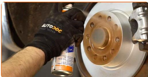
**18** Reinigen Sie die Oberfläche an welcher die Felge montiert werden soll. Benutzen Sie einen Bremsenreiniger.
