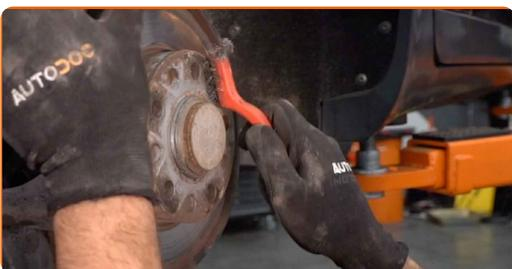
**14** Entfernen Sie den Haltering. Benutzen Sie ein Brecheisen.
