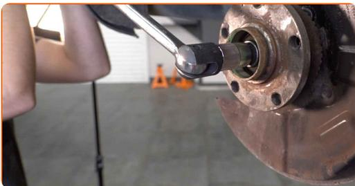
**18** Entfernen Sie die Befestigungsschraube.
