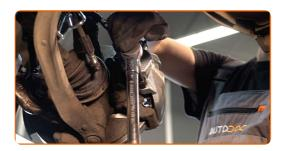
25 Installieren Sie die Staubschutzkappen der Bremssattel-Führungsstifte.
