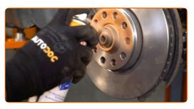
Die Bremsscheibenoberfläche reinigen. Benutzen Sie einen Bremsenreiniger.
