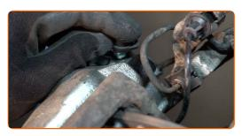
Entlüften Sie das Bremssattelsystem. Ohne das Starten des Motors drücken Sie das Bremspedal mehrmals, bis Sie signifikanten Widerstand spüren.
