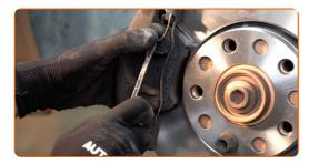
15 Entfernen Sie den Bremssattel.
