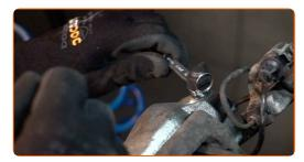
Trennen Sie den Schlauch des Bremsentlüftungs-Kits.
