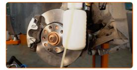
Lösen Sie die Bremsentlüftungsschraube. Verwenden Sie Ring-Gabelschlüssel Nr. 10.
