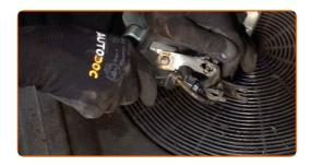
Sichern Sie den Bremsschauch-Befestigungswinkel. Verwenden Sie Stecknuss Nr. 11. Verwenden Sie einen Ratschenschlüssel.
