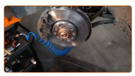
Reinigen Sie das Befestigungselement der Bremsleitung. Benutzen Sie eine Drahtbürste. Benutzen Sie einen Bremsenreiniger.
