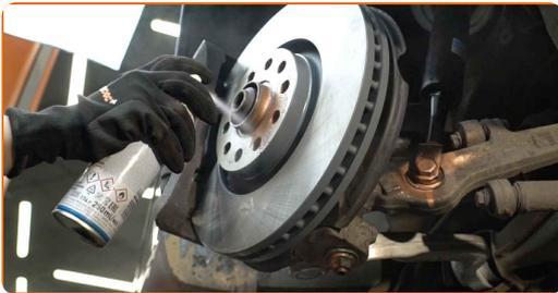
**36** Die Bremsscheibenoberfläche reinigen. Benutzen Sie einen Bremsenreiniger.
