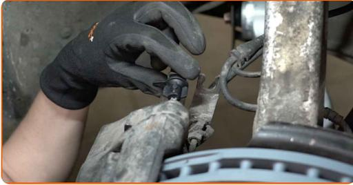
**34** Verbinden Sie den Stecker des Verschleißsensors der Bremsbeläge.
