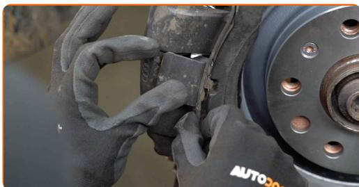
**33** Verbinden Sie den Bremsbelag-Verschleiß-Sensor.
