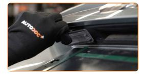
Schrauben Sie die Befestigung des Gehäuses der Kennzeichenleuchte ein. Verwenden Sie einen Kreuzschlitzschraubendreher.
