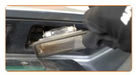
Behandeln Sie die Steckverbinder der Kennzeichenleuchte. Verwenden Sie dielektrisches Fett. Verwenden Sie einen flachen Schraubendreher.
