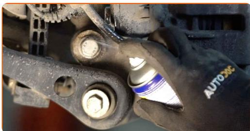
**9** Schrauben Sie den unteren Befestiger des Stoßdämpfers ab. Verwenden Sie Ring-Gabelschlüssel Nr. 21. Verwenden Sie Stecknuss Nr. 21. Verwenden Sie einen Ratschenschlüssel.
