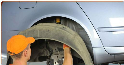
**8** Reinigen Sie die Stoßdämpferbefestigungen. Benutzen Sie eine Drahtbürste. Benutzen Sie WD-40-Spray.
