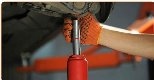
**11** Entfernen Sie die Befestigungsschraube.
