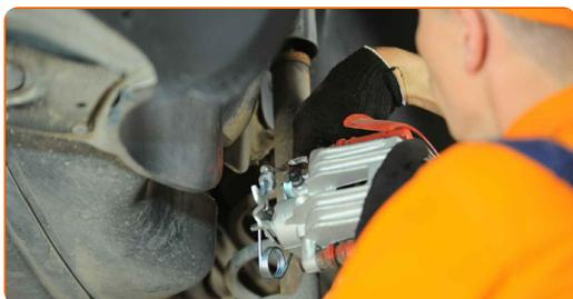
**21** Lösen Sie die Bremsentlüftungsschraube. Verwenden Sie einen offenen Ringschlüssel #10.
