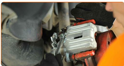
**Austausch: Bremssattel – AUDI A4 Limousine (8E2, B6). Tipp von AUTODOC:**
