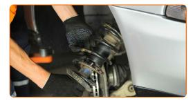
Sichern Sie die oberen Befestigungen des Federbeines.
