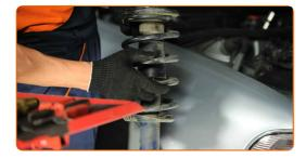
Stellen Sie das Dämpferbein auf das Federspannwerkzeug.
