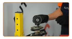
Ziehen Sie die Federbeinkolbenstangenmutter an. Verwenden Sie Stecknuss Nr. 18. Verwenden Sie Inbusschlüssel Nr. H6. Verwenden Sie einen Drehmomentschlüssel. Ziehen Sie ihn mit 50 Nm Drehmoment fest.
