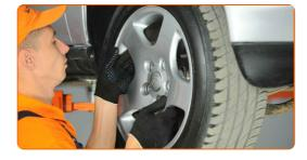
Reinigen Sie die Befestigungsschraube, die die Stoßdämpfergabel mit dem unteren Querlenker verbindet. Benutzen Sie eine Drahtbürste. Benutzen Sie WD-40-Spray.
