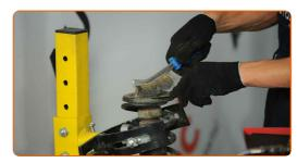
Entfernen Sie die Stangenmutter des Federkolben. Verwenden Sie Stecknuss Nr. 18. Verwenden Sie einen Ratschenschlüssel.
