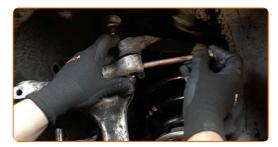
Ziehen Sie die Befestigung des oberen Arms an. Verwenden Sie Ring-Gabelschlüssel Nr. 17. Verwenden Sie Stecknuss Nr. 17. Verwenden Sie einen Drehmomentschlüssel. Ziehen Sie ihn mit 40 Nm Drehmoment fest.
