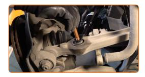
Bringen Sie die Querlenker an. Verwenden Sie einen Gummi-Hammer.
