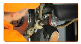
Entfernen Sie den Träger unter dem Achsschenkel.
