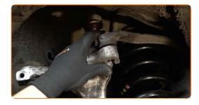
Bringen Sie die Befestigungsschraube an. Verwenden Sie einen Splintentreiber. Benutzen Sie einen Hammer.
