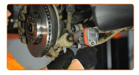
8 Entfernen Sie die Befestigungsschraube.
