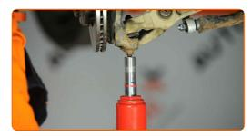
Ziehen Sie die Befestigungsschraube an, die die Stoßdämpfergabel mit dem unteren Querlenker verbindet. Verwenden Sie Ring-Gabelschlüssel Nr. 18. Verwenden Sie Stecknuss Nr. 18. Verwenden Sie einen Drehmomentschlüssel. Ziehen Sie ihn mit 90 Nm Drehmoment fest.
