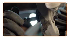
Schrauben Sie die Befestigungen des unteren Arms ab. Verwenden Sie Ring-Gabelschlüssel Nr. 17. Verwenden Sie Stecknuss Nr. 17. Verwenden Sie einen Ratschenschlüssel.
