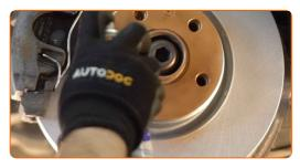
Die Bremsscheibenoberfläche reinigen. Benutzen Sie einen Bremsenreiniger.
