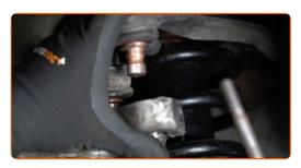
Lösen Sie den unteren Bereich des Federbeins.
