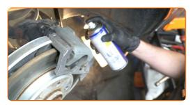
Schrauben Sie die Befestigung des Bremssattels ab. Verwenden Sie Ring-Gabelschlüssel Nr. 15. Verwenden Sie Stecknuss Nr. 13. Verwenden Sie einen Ratschenschlüssel.
