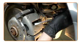
11 Entfernen Sie den Bremssattel.
